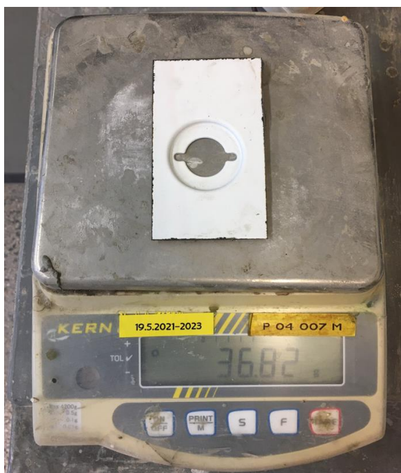
Obrázek 25: Vážení vzorku na váze Kern
