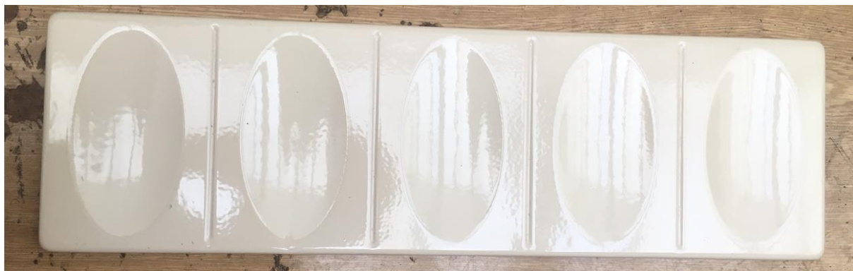
Obrázek 30: Krycí smalt po 1 000 hodinách v kondenzační komoře
