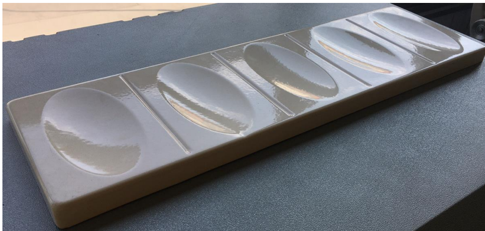
Obrázek 21: Vzorek č.1 se smaltovanou vrstvou [foto autora]
