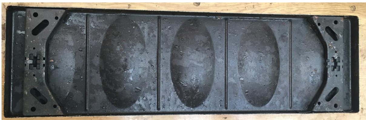
Obrázek 31: Základní smalt po 1 000 hodinách v kondenzační komoře
