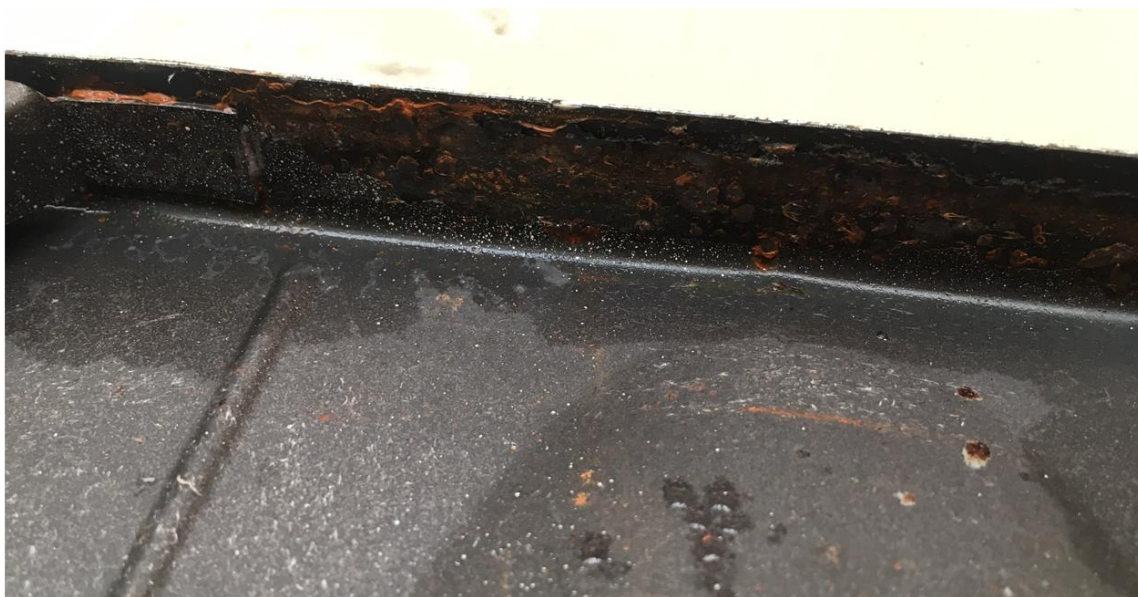
Obrázek 29: Koroze základního smaltu po 720 hodinách
