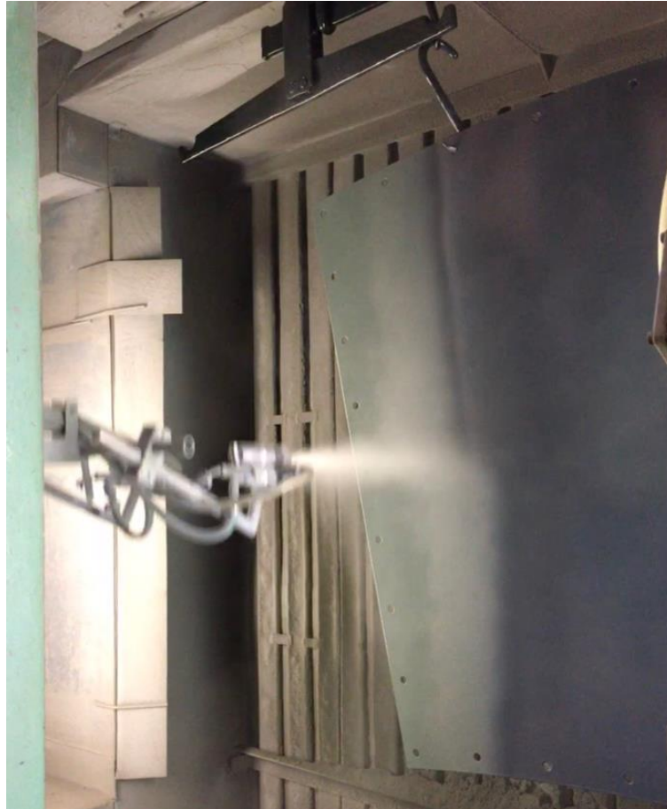
Obrázek 7: Stříkání smaltéřské břečky ve smaltovně Vítkovice [foto autora]
