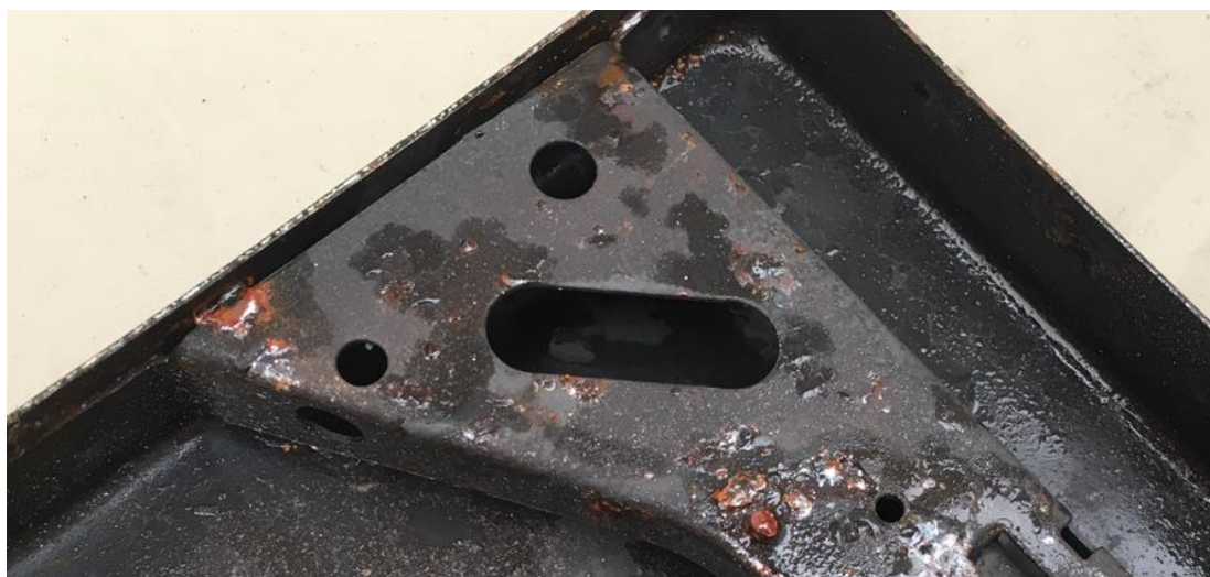
Obrázek 2: Koroze základního smaltu na rubu desky [foto autora]
