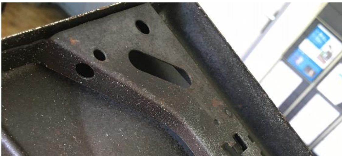
Obrázek 28: Základní smalt s mírnou povrchovou korozi po 480 hodinách
