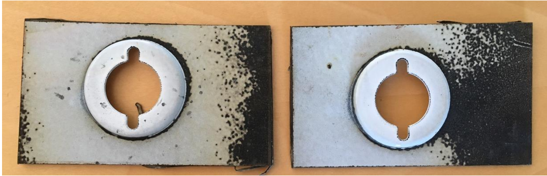
Obrázek 17: Oblasti krycího smaltu na rubu vzorků [foto autora]
