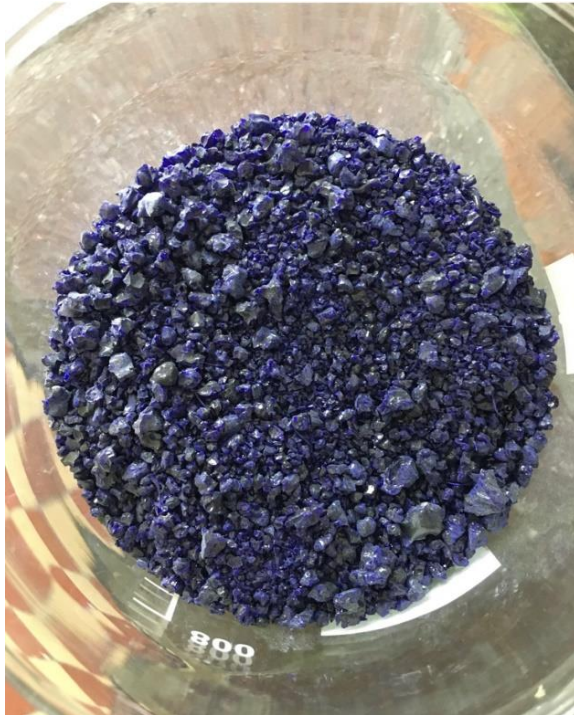
Obrázek 6: Smaltěřská fritra s oxidem kobaltnatým
