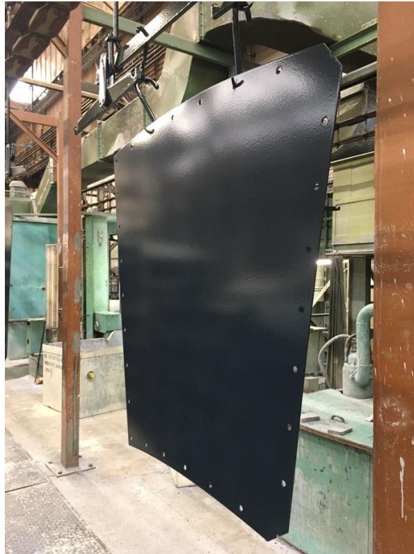
Obrázek 8: Smaltovaný plech po výjezdu z vypalovací pece [foto autora]
