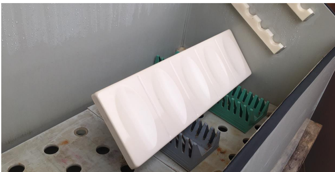
Obrázek 26: Umístění vzorku v kondenzační komoře
