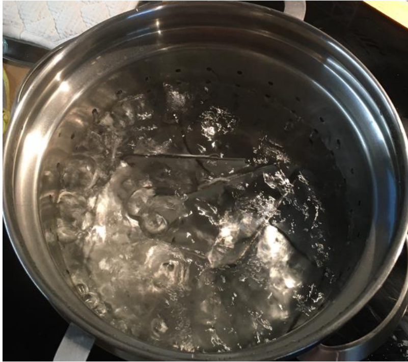
Obrázek 23: Průběh zkoušky ve vroucí destilované vodě [foto autora]
