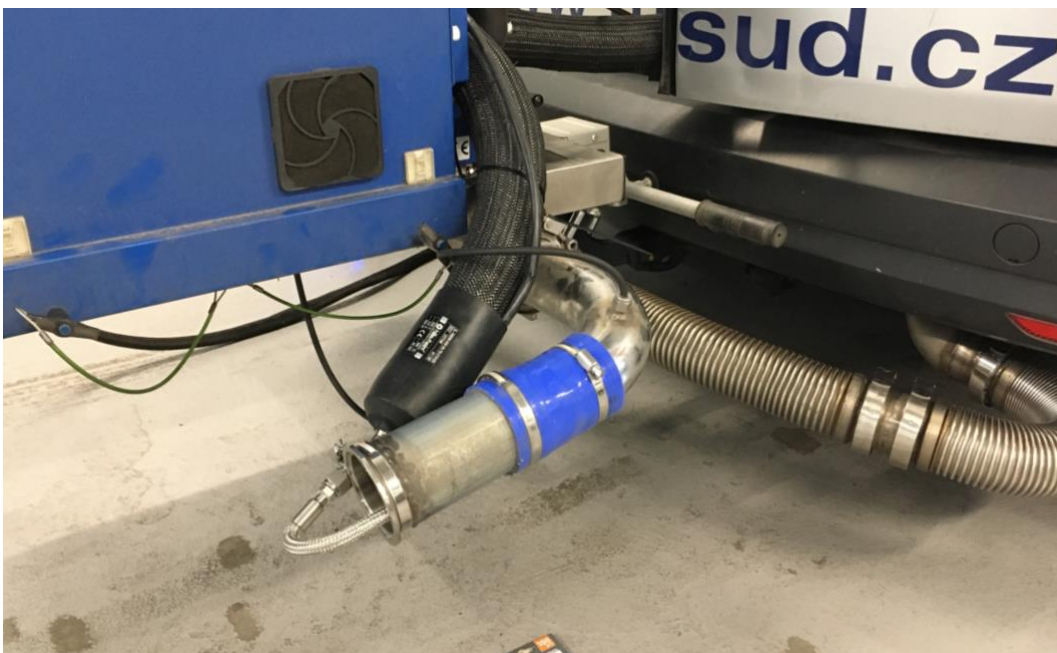
Obr. 8.4: Uchytenie sondy na odber výfukových plynov do odberného boxu
