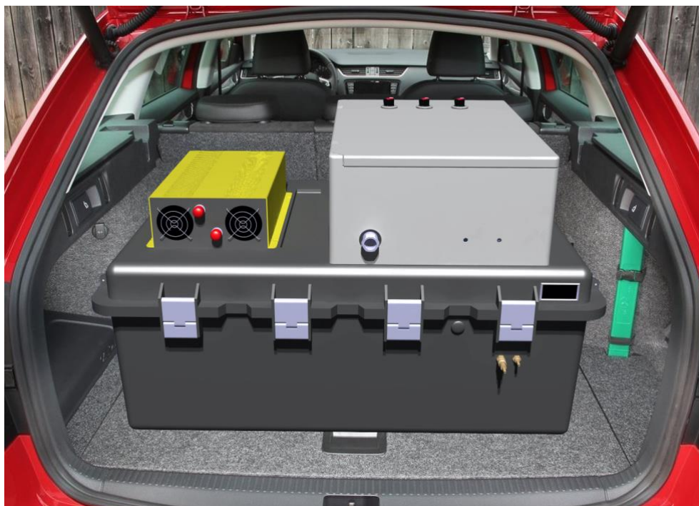
Obr. 7.15: Príklad uloženia odberného boxu vo vozidle 2 [29]
