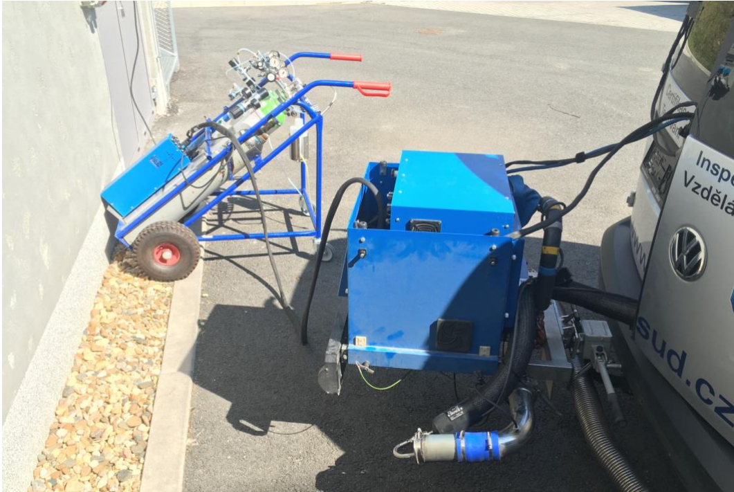
Obr. 8.5: Kalibrácia systému PEMS pred meraním skúšky RDE
