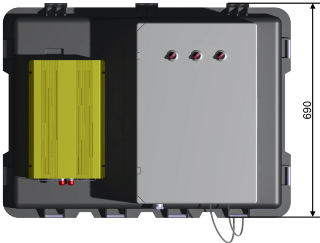
Obr. 7.22: Približná šírka vyrobeného boxu
