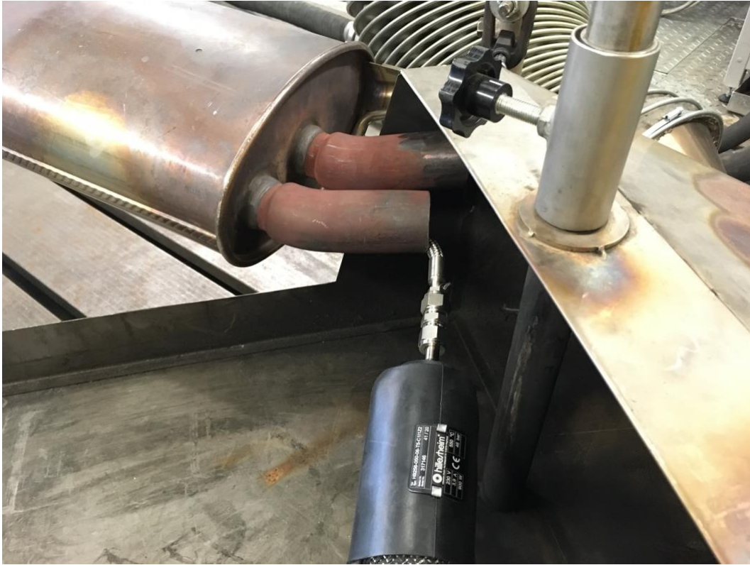
Obr. 7.24: Zavedenie odbernej sondy do výfukového potrubia
