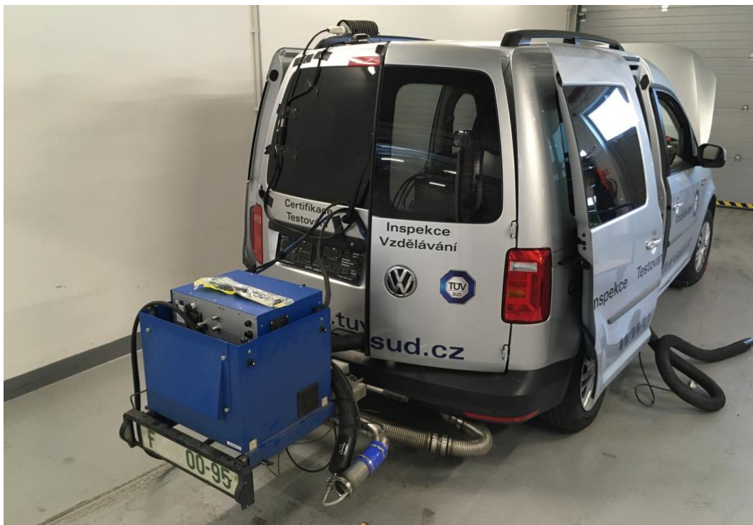
Obr. 8.3: Zariadenie PEMS uchytené na skúšanom vozidle
