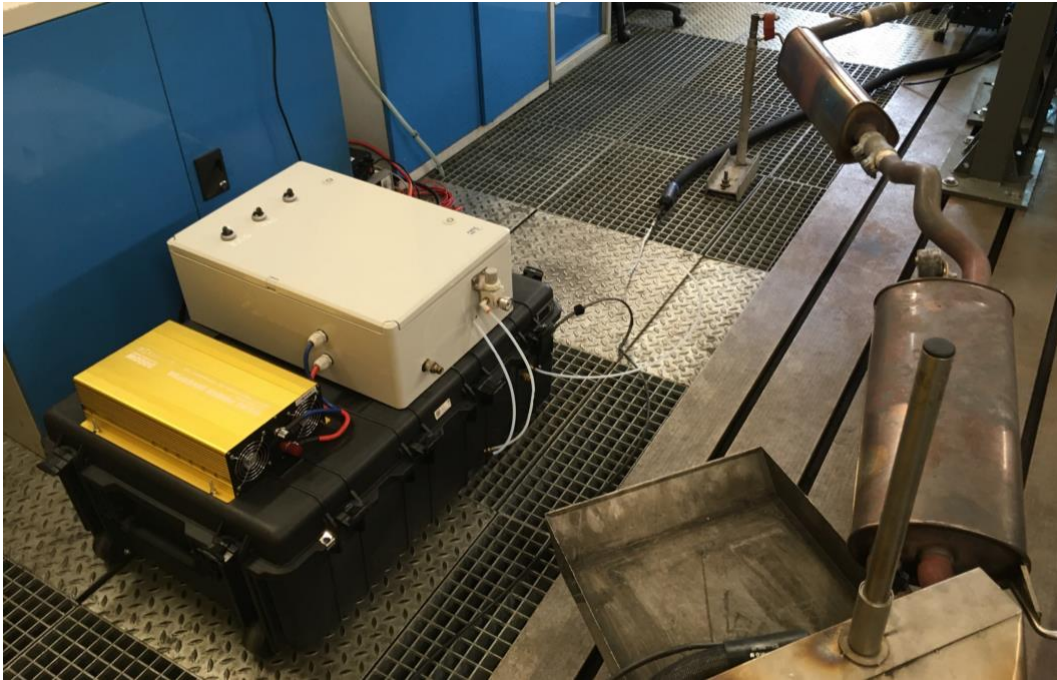
Obr. 9.1: Analýza výfukových plynov z odberného boxu uložených počas skúšky RDE
