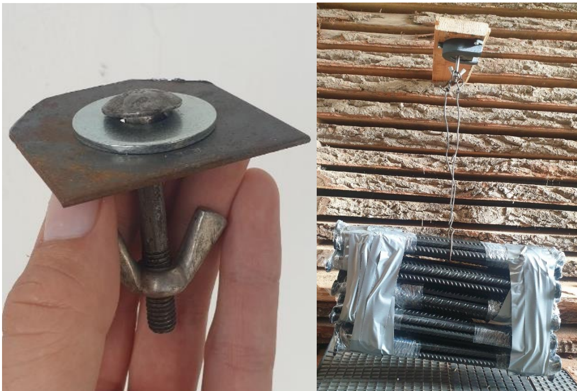
Obr. 56: Přípravek pro zavěšení závaží a držák zatížený závažím 55 kilogramů
