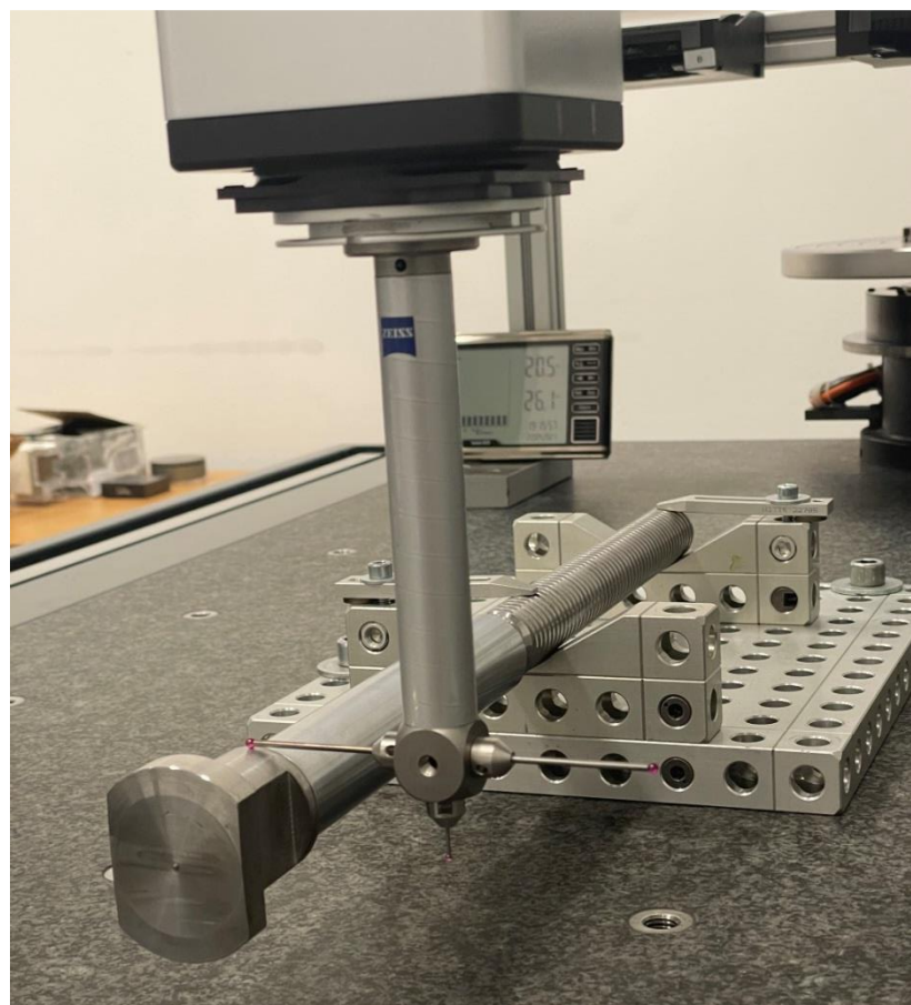
Obrázek 83: Měření vybraného dílu konfigurací snímačů +-X
