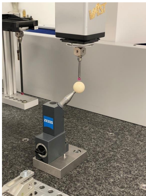
Obrázek 81: Zaměření kalibrační koule referenčním snímačem
