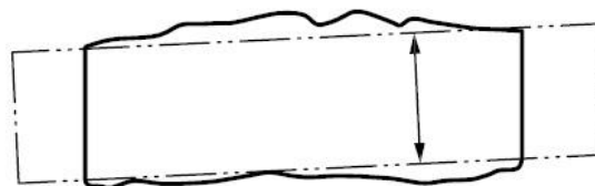
Obrázek 3: Metoda přiřazení maximálního vepsaného rozměru [10]
