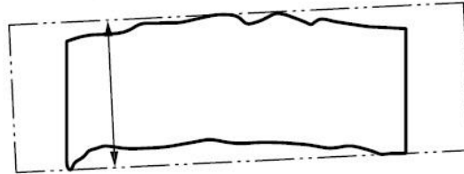
Obrázek 4: Metoda přiřazení minimálního opsaného rozměru [10]
