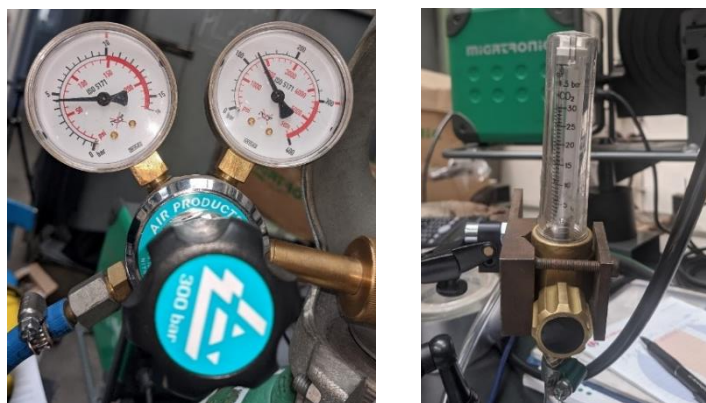
Obrázek 4.4 Redukční ventil a průtokoměr
