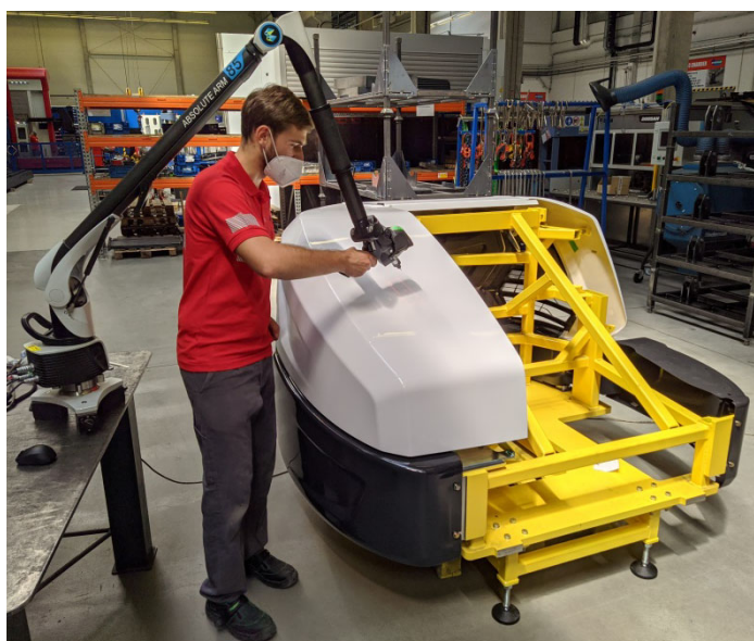
Obr. 6-43 – Skenování krytů pomocí měřicího ramene
