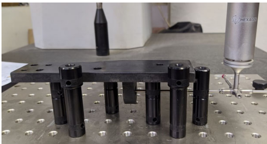
Obr. 6-31 – Měření součásti na TIGO SF s využitím sady Swift-Fix
