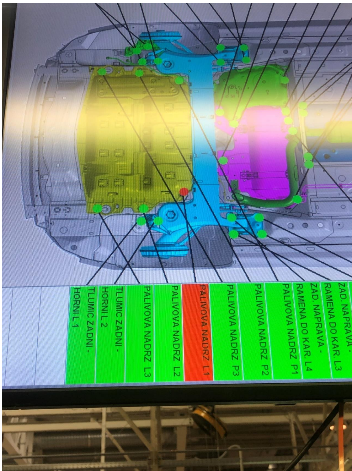
Obrázek 30 Chyba utažení - červené pole
