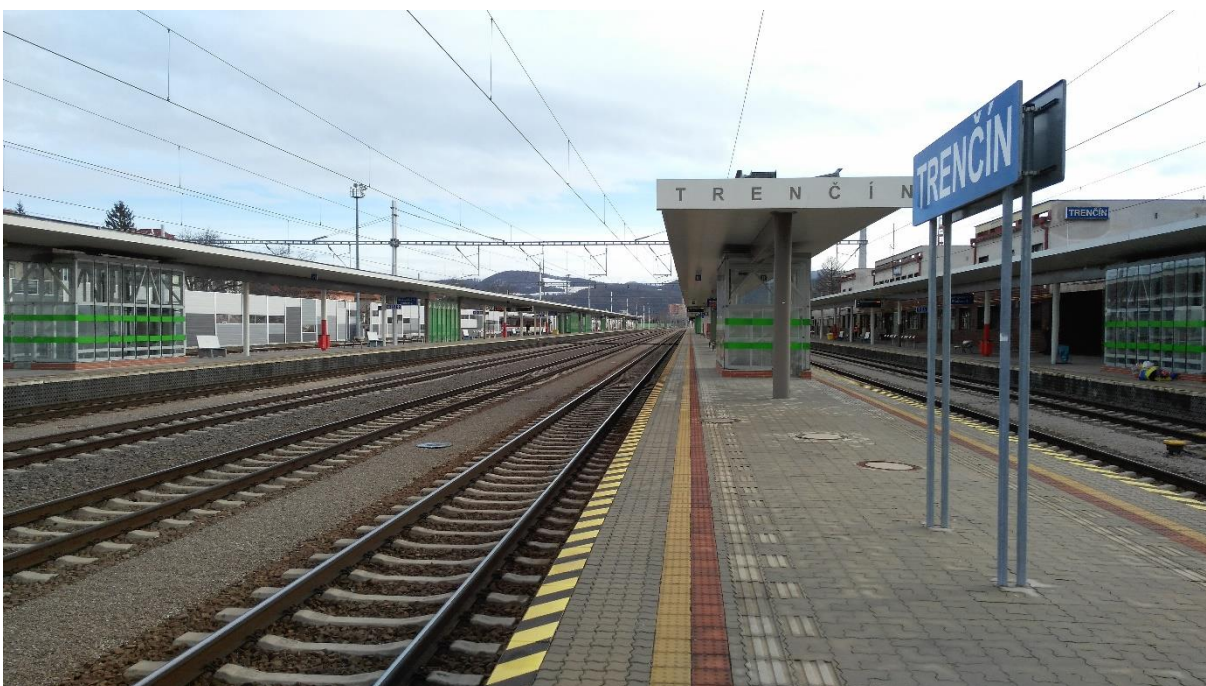
30.1.2020, Žst. Trenčín [Slovensko], nást. 2., aktuální vyhotovení ochranných pásů na nástupištích na síti ŽSR, viditelné odsunutí nástupišť od hlavních dopravních kolejí ke kolejím předjízdným s nižší rychlostí
