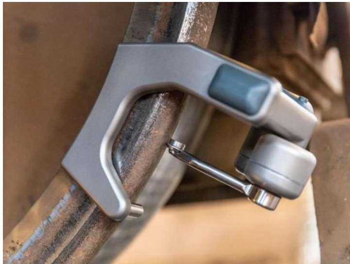
Obr. 3: Měřicí přístroj MiniProf [9]
