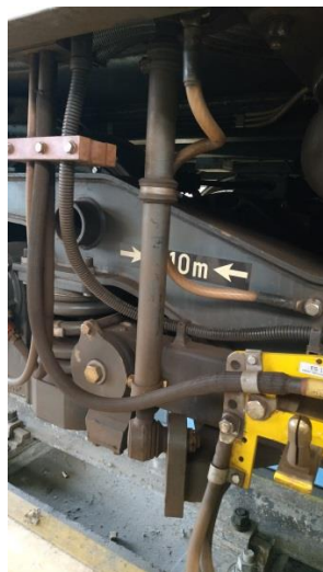
Obr. 21: Torzní stabilizátor (vlevo) a vertikální tlumič (vpravo)
