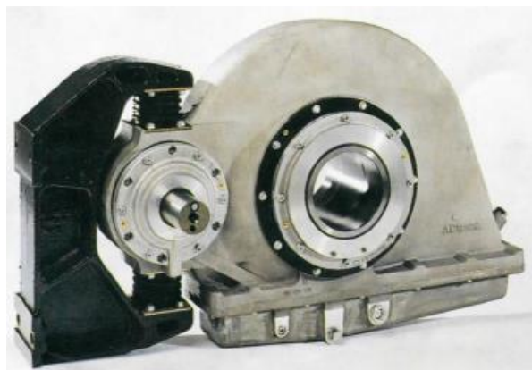
Obr. 30: Nápravová převodovka pohonu vozu M1 [3]
