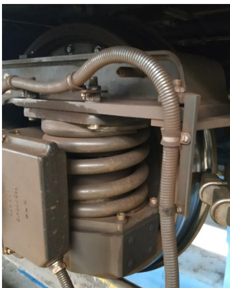
Obr. 19: Detail primárního vypružení vozu M1.1
