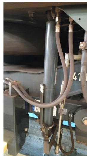
Obr. 21: Torzní stabilizátor (vlevo) a vertikální tlumič (vpravo)
