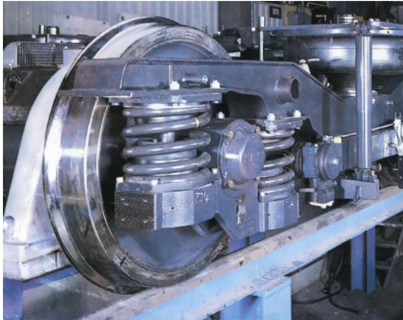
Obr. 31: Primární vypružení vozu M1 [3]
