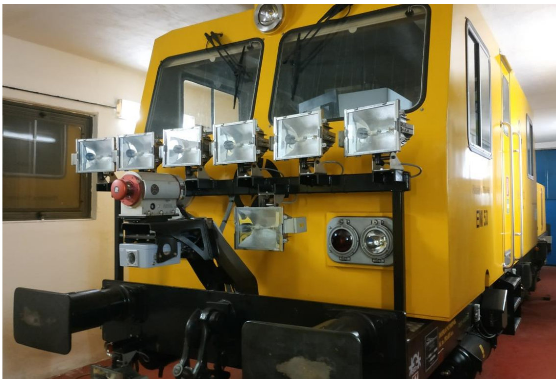
Obr. 46: Měřicí vůz kolejového svršku Plasser & Theurer EM 50
