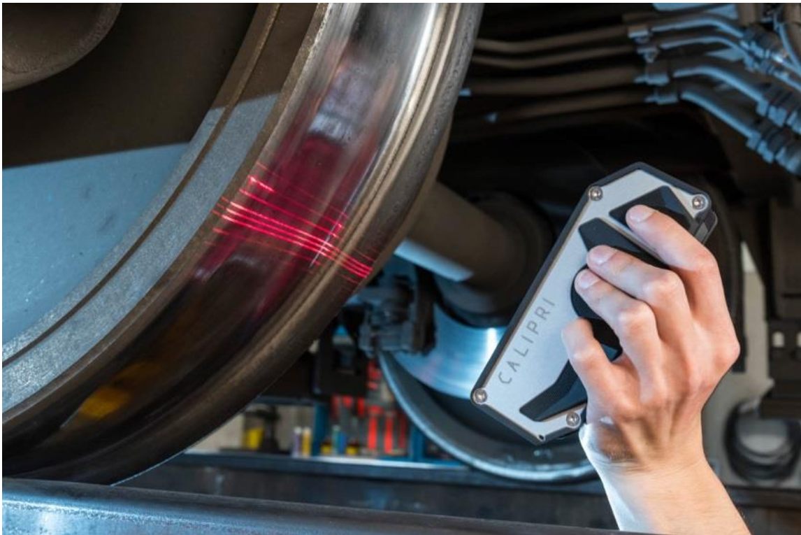
Obr. 4: Měření jízdního profilu přístrojem Calipri [8]
