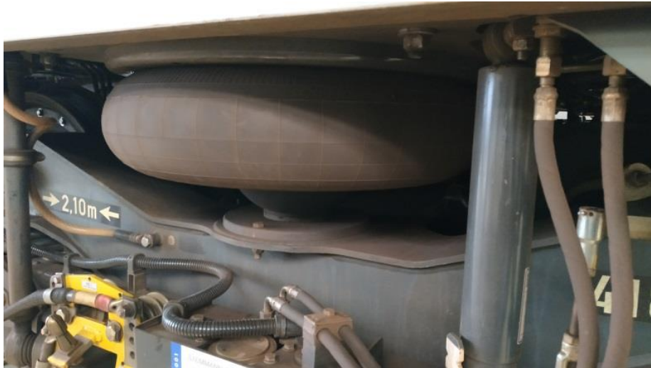
Obr. 20: Sekundární vypružení - zástavba
