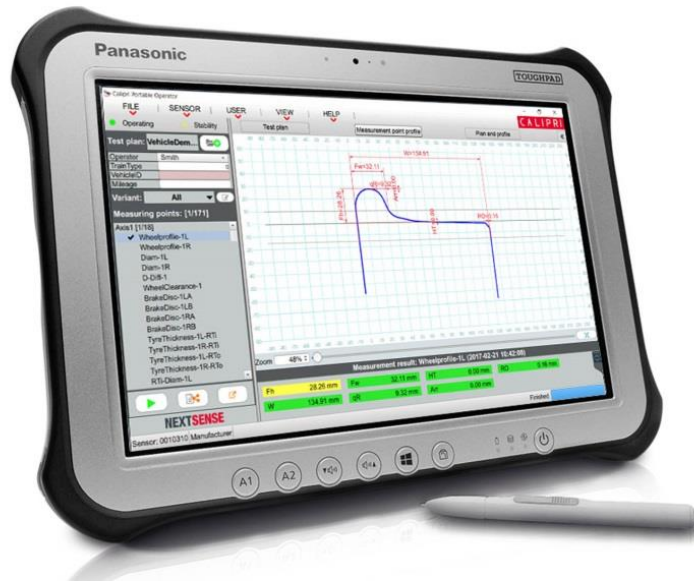
Obr. 5: Grafické zobrazení naměřených dat Calipri [8]
