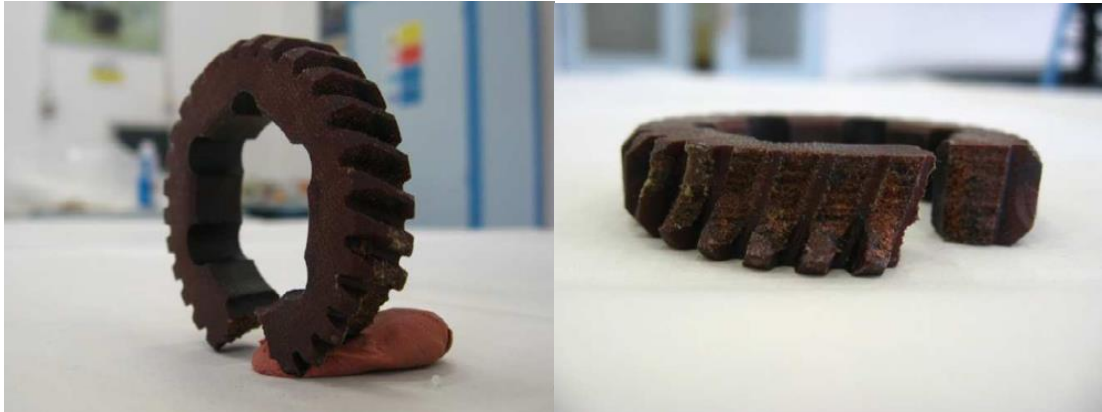
Obrázek 8: Poškozené ozubené kolo [9]
