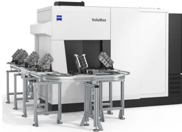
Obrázek 35: Vlevo tomograf řady BOSELLO, vpravo řada VoluMax [39]
