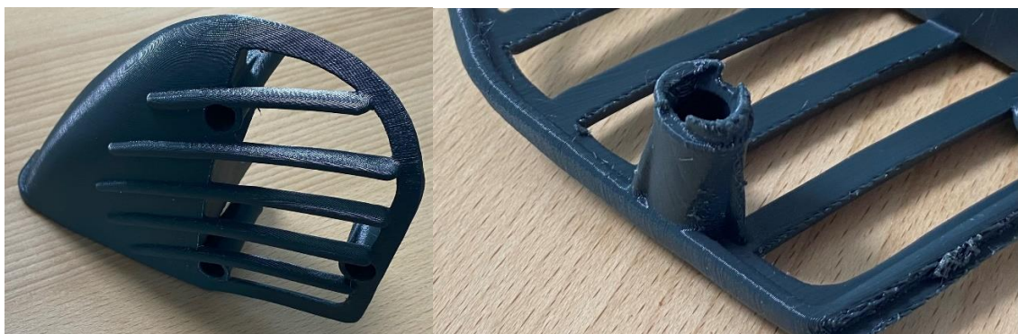
Obrázek 94: Pravý kryt karburátoru vytvořený tiskem upraveného STL
