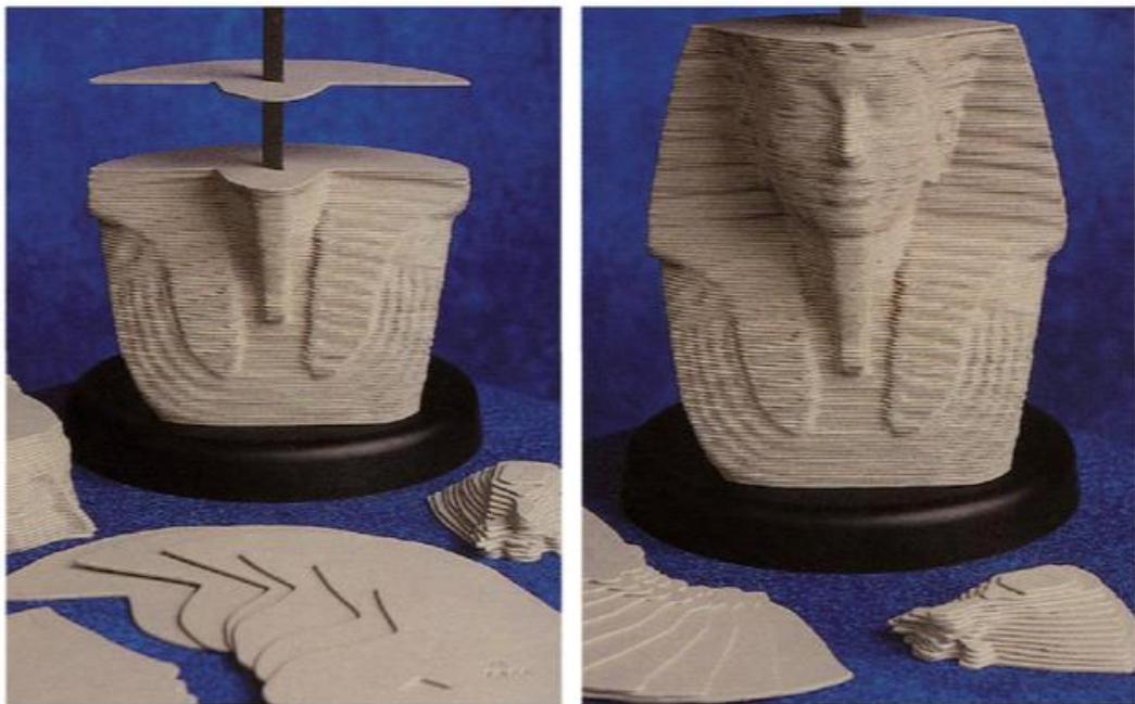
Obrázek 36: Podstata skládání vrstev při aditivní výrobě [41]
