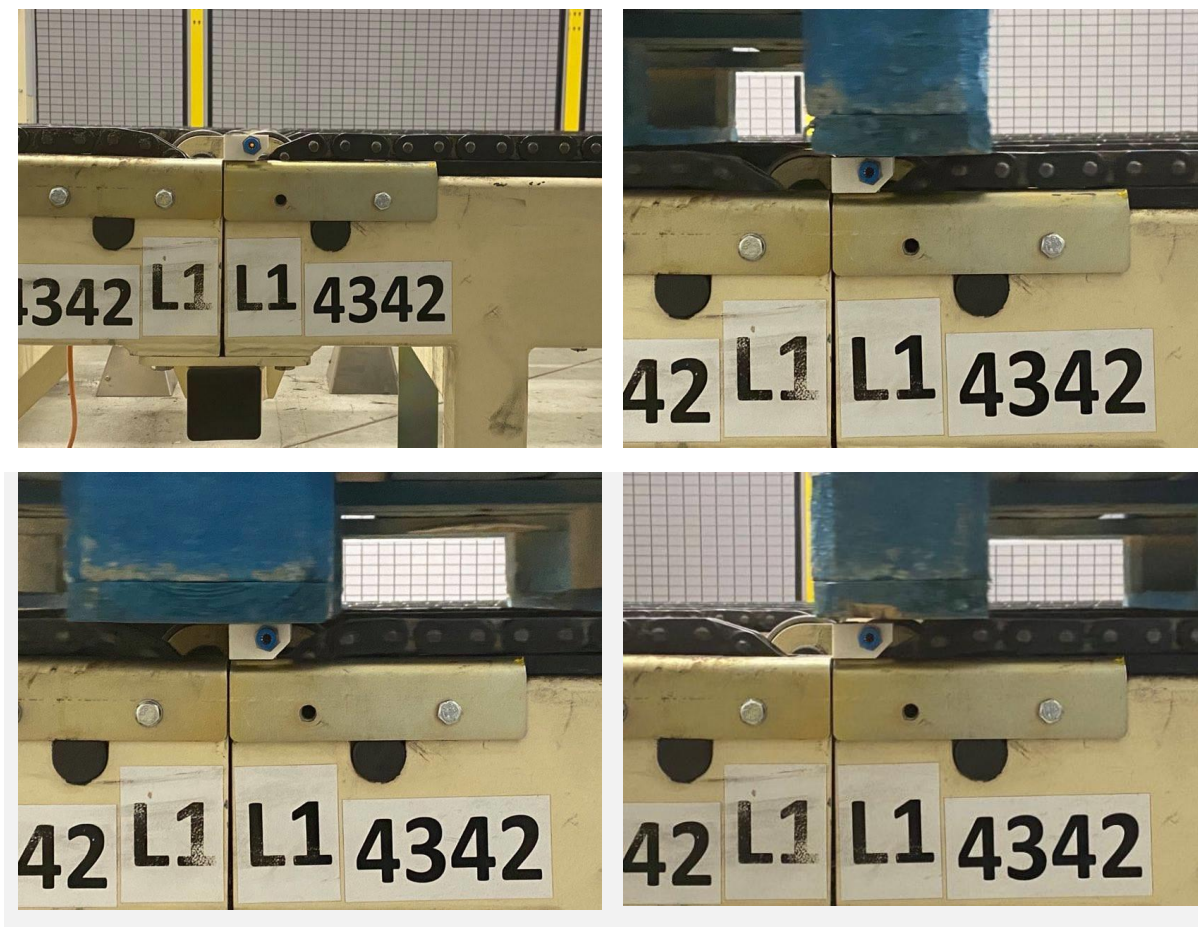
Obrázek 39: Test projetí palety.
