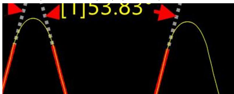
Obrázek 59 Detail zaoblené vnější plochy závitů M11 x 1 – 6h při zvětšení x50 mikroskopem VHX 7000
