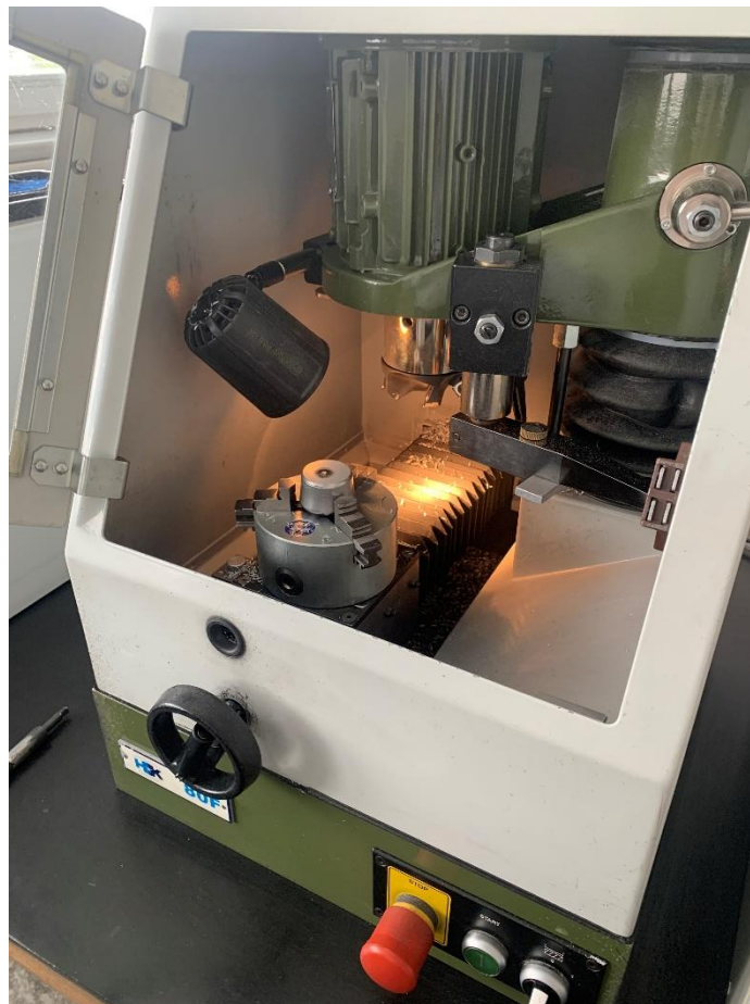
Obrázek 8.1 Příprava povrchu vzorku před analýzou chemického složení na vertikální frézce HK 80F
