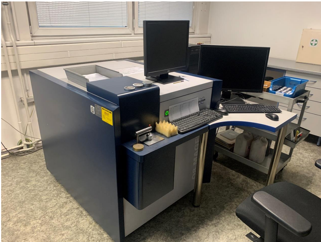
Obrázek 8.2 Jiskrový optický emisní spektrometr Bruker-Quantron Q8 Magellan ve Škoda Auto a.s.
