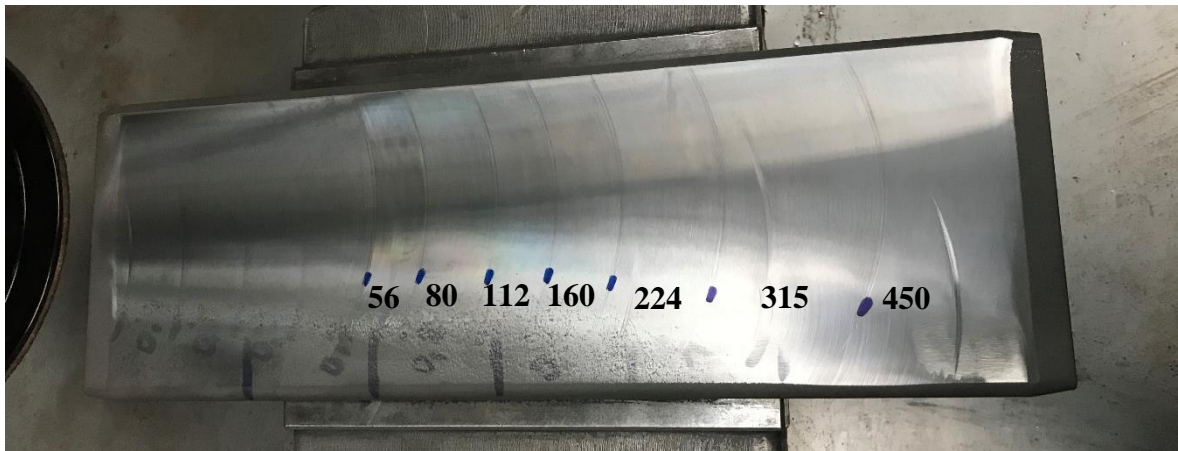
Obr. č. 36 Povrch broušený různým posuvem
