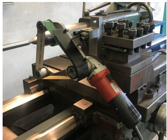
Obr. č. 41 a) Pásová bruska trubek 1401 EK [44] b) uchycení pásové brusky v soustruhu
