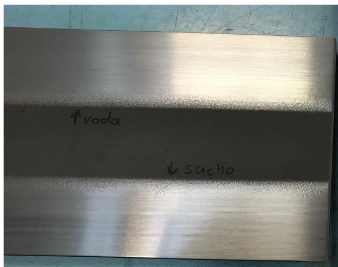
Obr. č. 54 Vzorek č. 6 po broušení s vodou a na sucho
