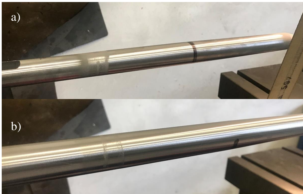
Obr. č. 45 Porovnání žárového nástřiku a) po 1. broušení b) po 2. broušení
