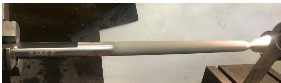
Obr. č. 39 Trn s žárovým nástřikem uchycen v soustruhu
