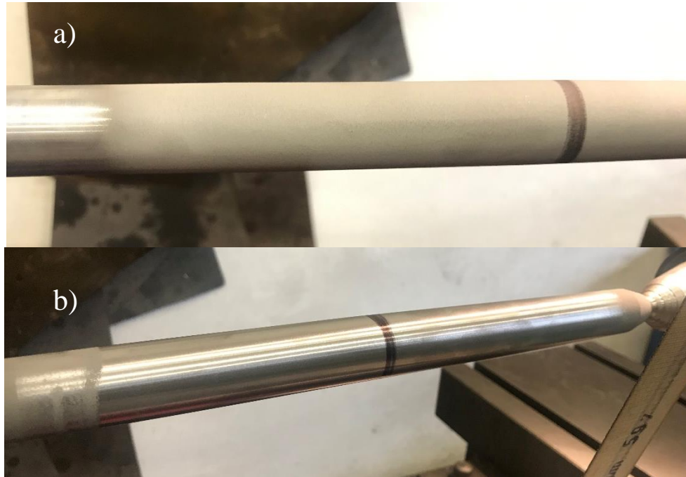
Obr. č. 44 a) původní povrch trnu s žárovým nástřikem b) žárový nástřik trnu po 1. broušení
