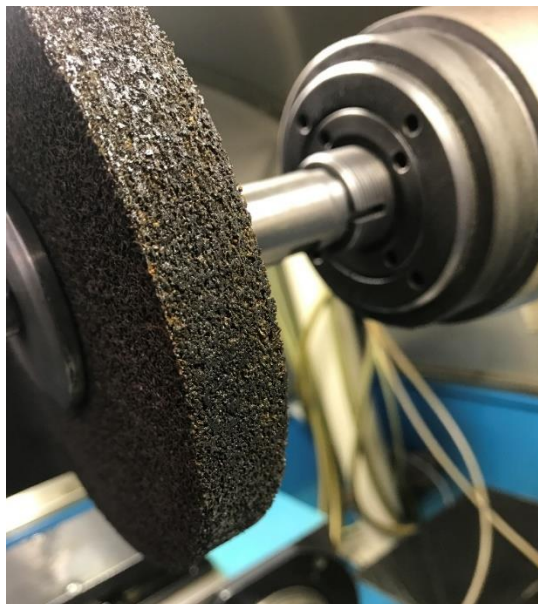
Obr. č. 55 Vzhled brusného kotouče NORTON po broušení šesti vzorků
