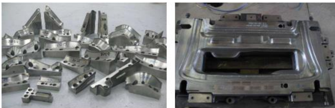
Obr. 11 Vlevo příklady střížných nástrojů, vpravo forma na lisování plechů [24]
