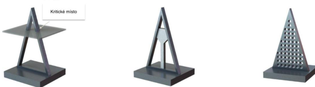
Obrázek 30 - Umístění podpěr a perforování součásti otvory [33]
