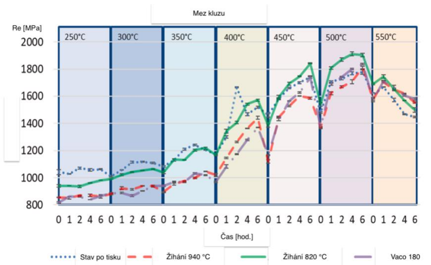
Obrázek 37 - Závislost meze kluzu na TZ jednotlivých vzorků [8]
