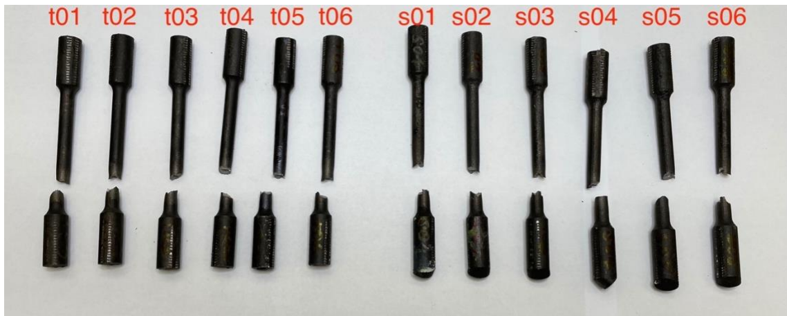
Obrázek 47 - Vzorky po zkoušce tahem
