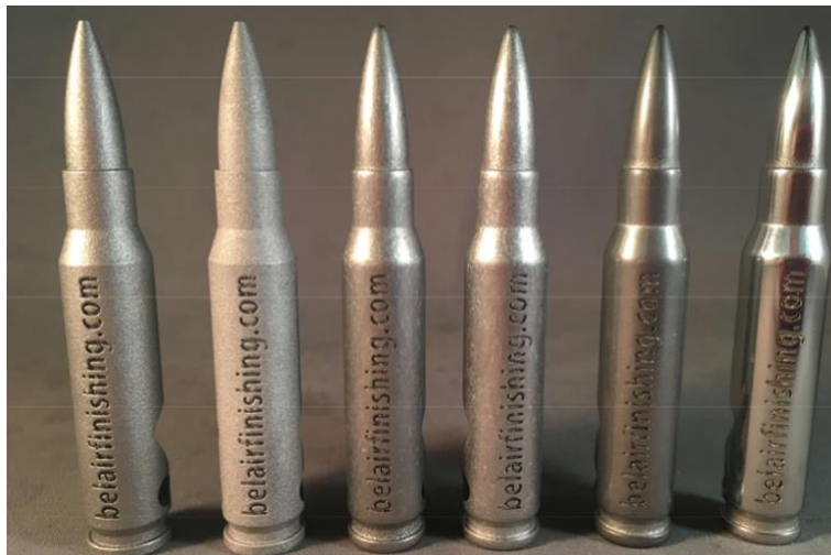
Obrázek 16 - Vliv obrábění na kvalitu povrchu tisknuté součásti [30]
