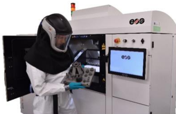
Obrázek 13 - Vyjmutí součásti ze stroje [10]
