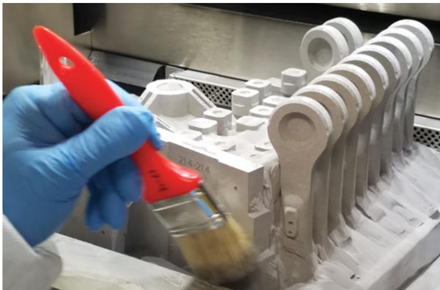
Obrázek 14 - Čištění součásti od kovového prášku [28]
