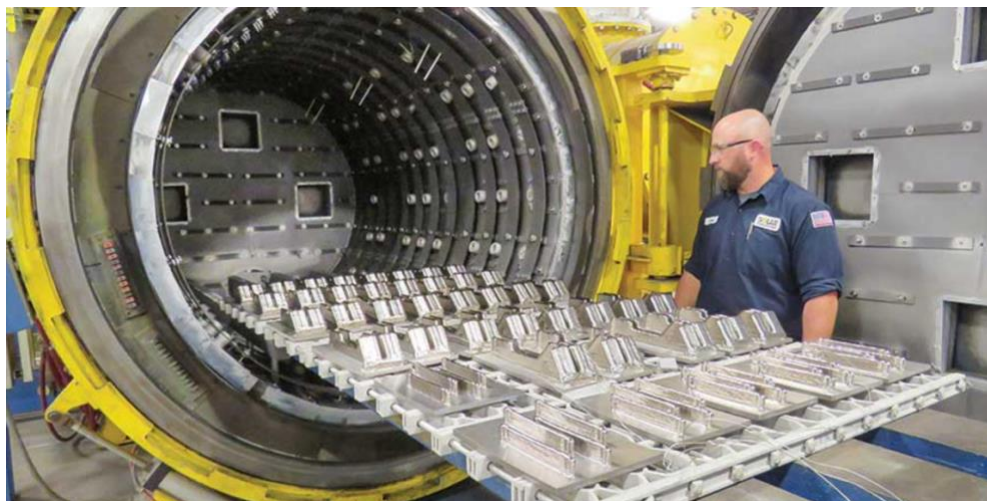
Obrázek 15 - Žíhání vytisknutých součástí [28]
