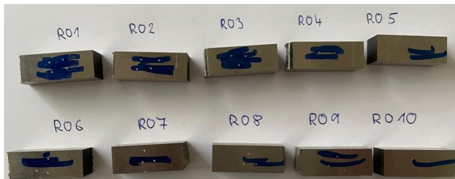
Obrázek 52 - Vzorky po zkoušce tvrdosti dle Rockwella
