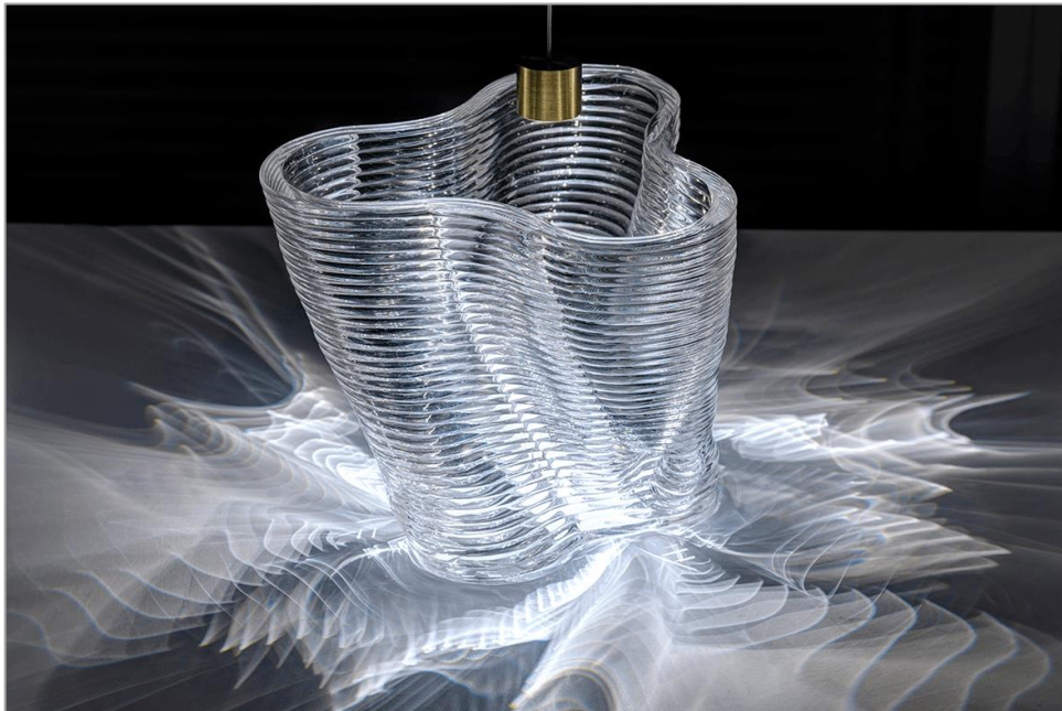
Obrázek 10 Ukázka 3D tisku roztaveného skla [17]
