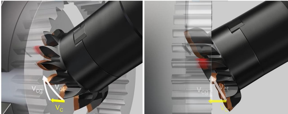
Obrázek 31 - Metoda Power skiving – vnitřní ozubení [21]
