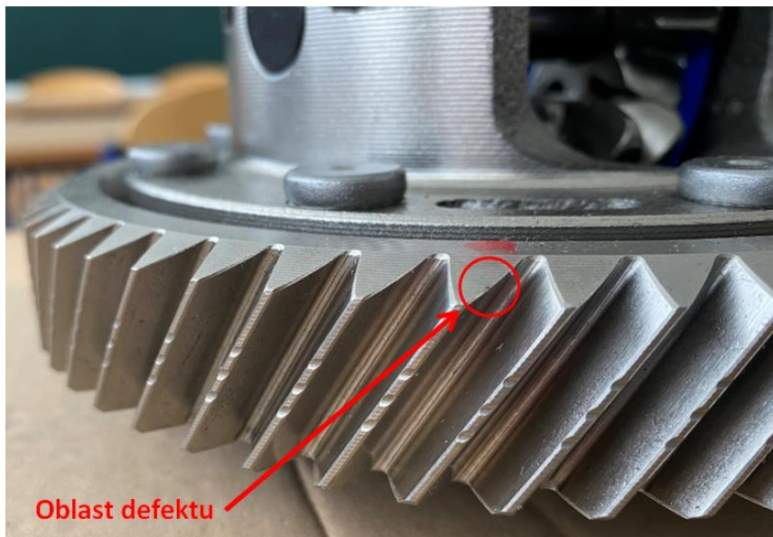
Obrázek 66 - Oblast defektu kola č. 1
