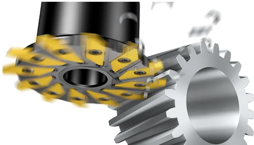
Obrázek 29 - Znárodnění metody InvoMilling společnosti Sandvik Coromant [17]
