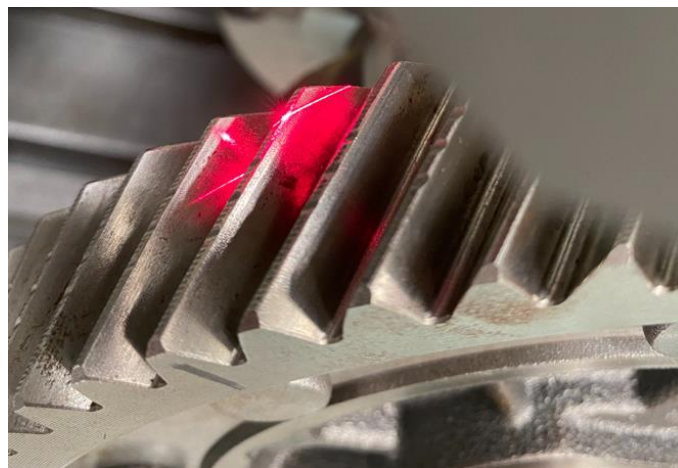
Obrázek 95 - Trajektorie laserového paprsku pod úhlem 40°
