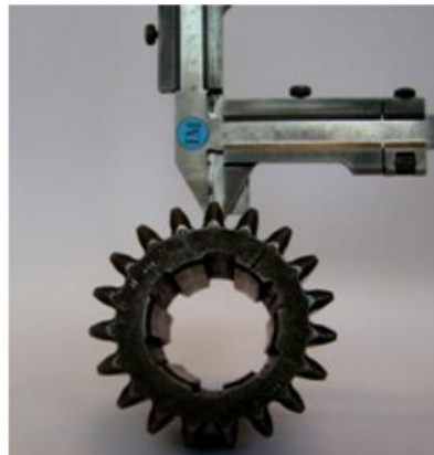
Obrázek 41 - Měření tloušťky zubu [28]
