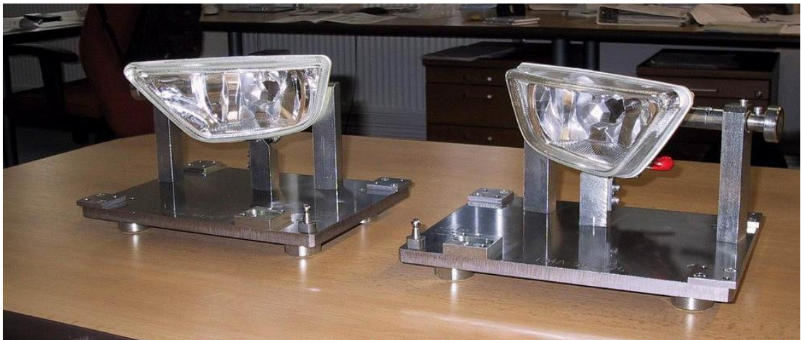
Obrázek 23: Příklad užití měřicího přípravku na měření světlometů
