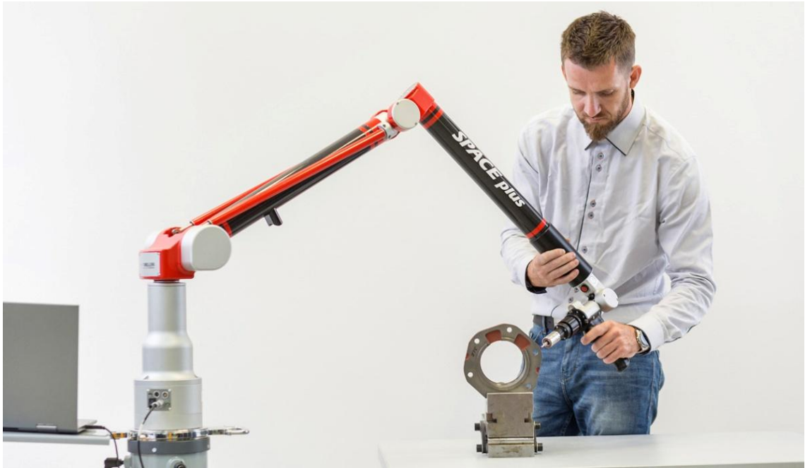
Obrázek 9: Měřící rameno s dotykovým snímacím systémem ovládané operátorem
