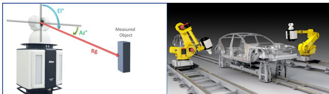
Obrázek 8: Schéma lase radaru snímajícího polohu dotyku a Laser radar začleněný do výrobní linky
