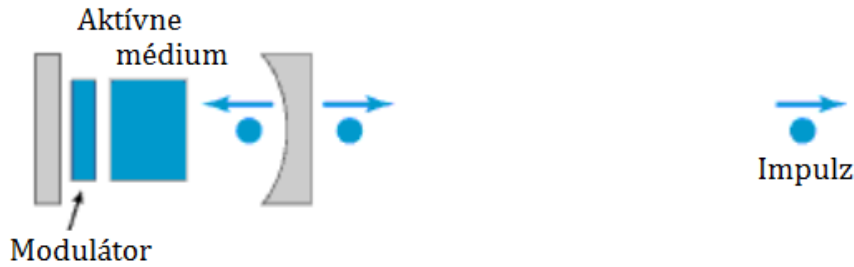
Obr. 1.6: Schematické nastavenie lasera s aktívnym mode-lockingom [24].
