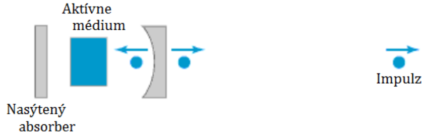
Obr. 1.7: Schematické nastavenie lasera s pasívnym mode-lockingom [24].
