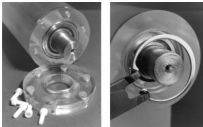
Obr. 27.: Nahrazení víčka pojistným kroužkem [15]
