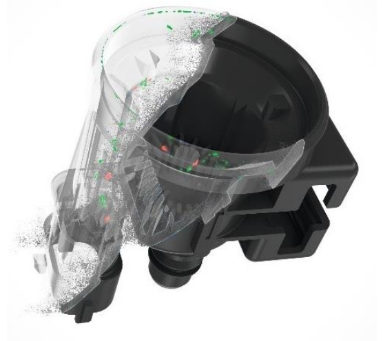
Principem je pořizování 2D snímků v 360° sledu. Obrázek 9 kontrola plastových dílů pomocí CT [17]
