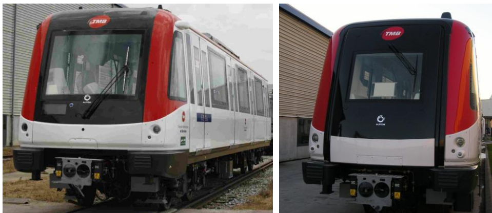
Obr. 21 Provedení čel jednotky S-9000; vlevo se stanovištěm strojvedoucího, vpravo autonomní jednotka, [10]
