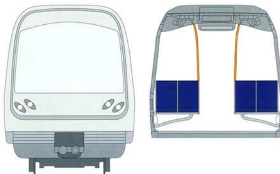
Obr. 26 Čelo a řez vozem jednotky AnsaldoBreda Driverless Metro Train, provedení pro Kodaň, [13]
