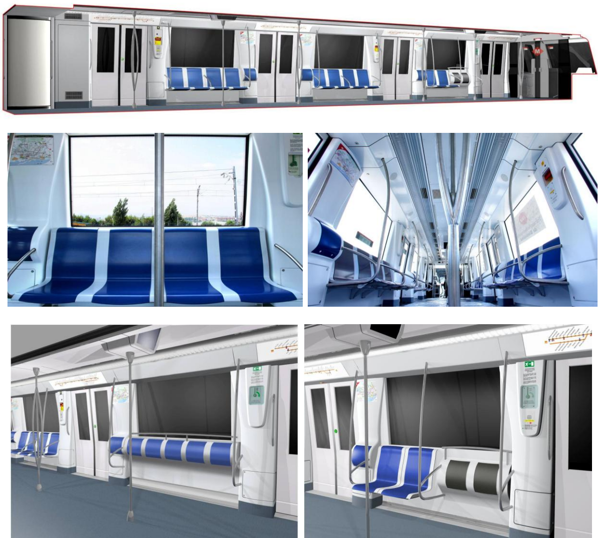
Obr. 20 Interiér jednotky S-9000 - opěrky pro cestující v běžném voze (R) - vlevo, prostor pro cestující s omezením pohybu v čelním voze (Ma) – vpravo; [10]
