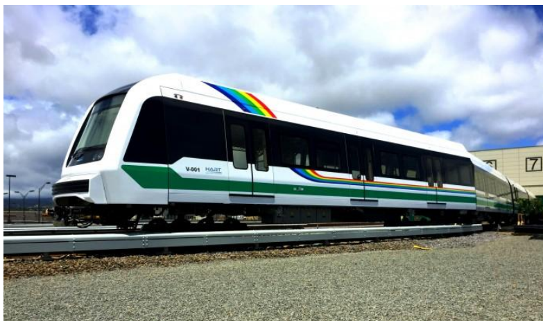
Obr. 29 Jednotka AnsaldoBreda, provedení pro Honolulu, na manipulačních podvozcích při zkouškách, [12]
