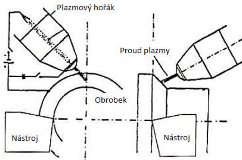
Obrázek 20 Soustružení s přidavným ohřevem [11]
