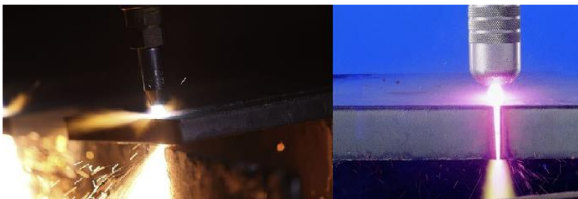
Obrázek 27 Ukázka řezání plamenem - obrázek vlevo a řezání plazmou - obrázek vpravo [1] [21]
