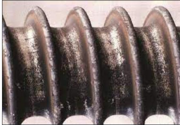
Obrázek 25 Návar na šroubovici dopravního šneku [16]
