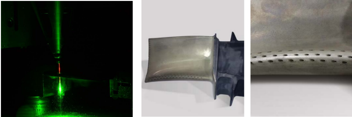
Obr. 6.6: Výroba otvorů v lopatce turbíny General Electric metodou LMJ [24, 52]
