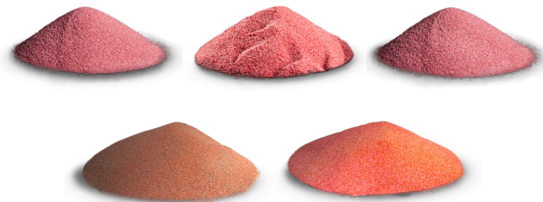
Obr. 5.4: Různé druhy přírodního granátu pro vodní paprsek [32]
