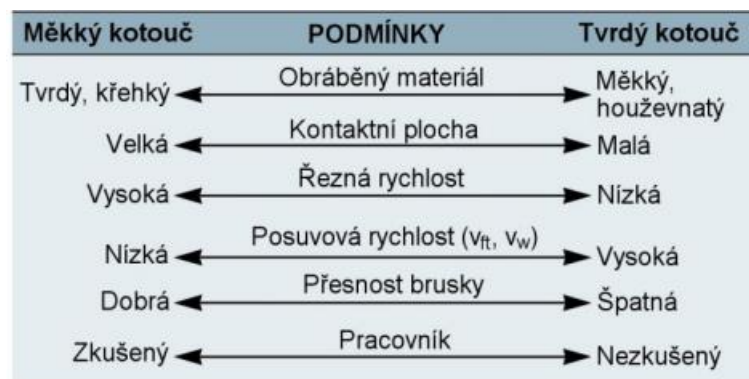
Obr. 20 - Volba brusného kotouče z pohledu tvrdosti [8]
