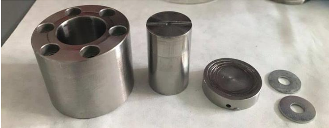
Obrázek 5 Speciální komponenty pro přípravu lisování cementu na hydraulickém laboratorním lisu.
