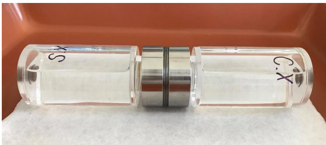
Obrázek 6 Zkompletovaná difúzní cela označená S.X – start bez přidání organické látky, C.X – cíl bez přidání organické látky. Rezervoáry jsou o objemu 160 ml.
