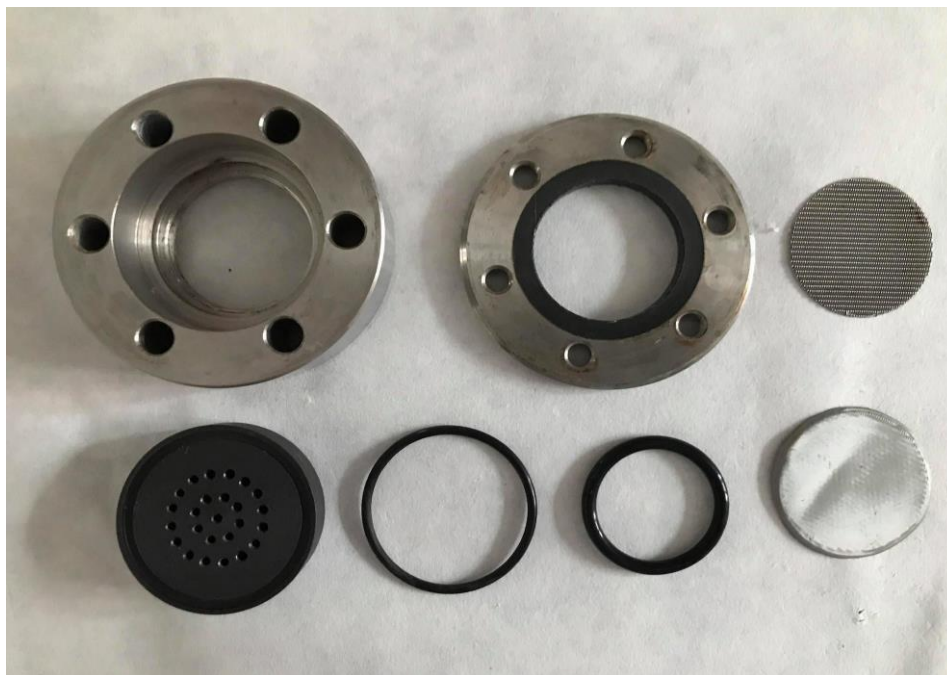
Obrázek 4 Komponenty difúzní cely. V horní řadě zleva doprava se nachází ocelové mezikruží, cela, nerezová membrána. V dolní řadě zleva doprava se nachází černý plastový filtr, tenká černá gumička, silná černá gumička, korozivzdorná kovová tkanina.
