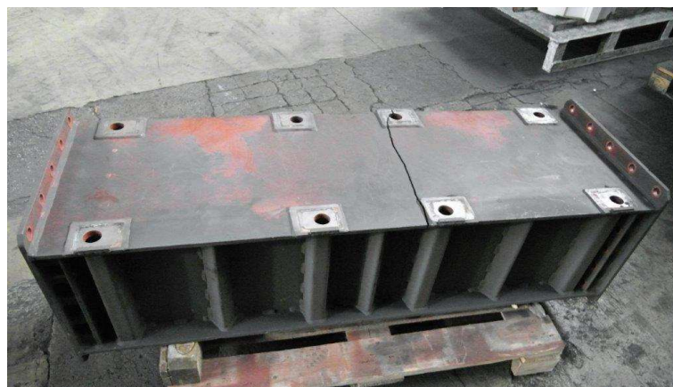
Obr. 40.: Poškozený příčník VA7 [1]
