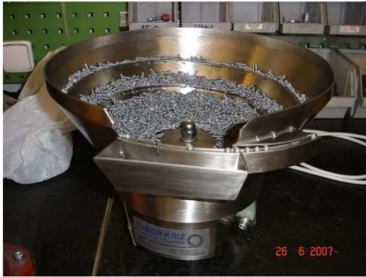
Obr. 3.: Kruhový vibrační zásobník [3]
