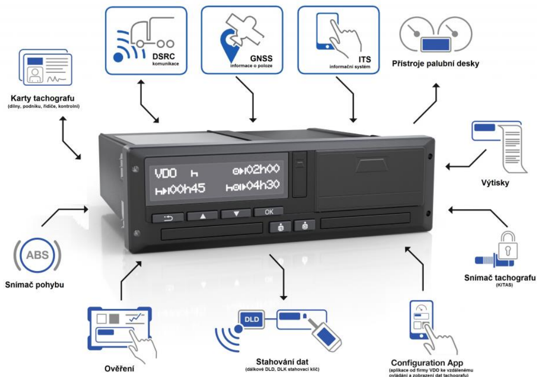
Obrázek 2: Inteligentní tachograf VDO DTCO 4.0 a jeho funkce [6]
