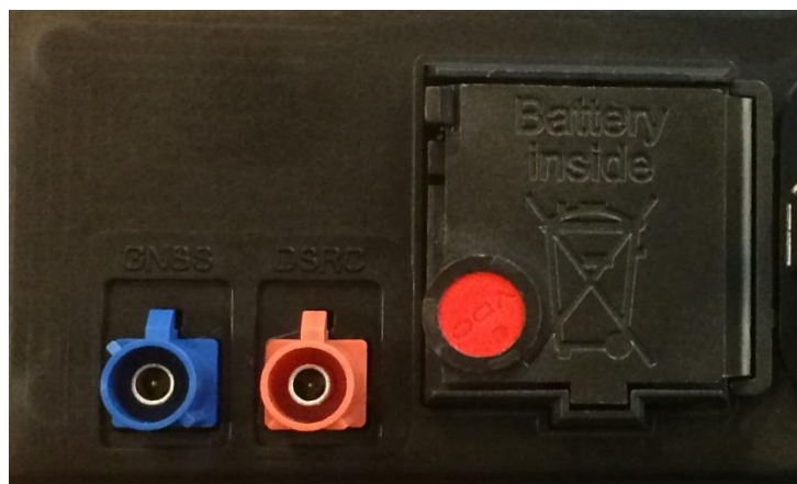
Obrázek 3: Nově zavedené konektory na zadní straně VU
