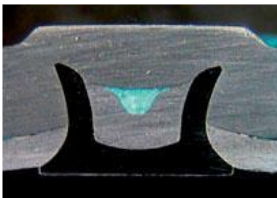
Obr. 16: Spojení pomocí Rivset nýtu-řez [15]
