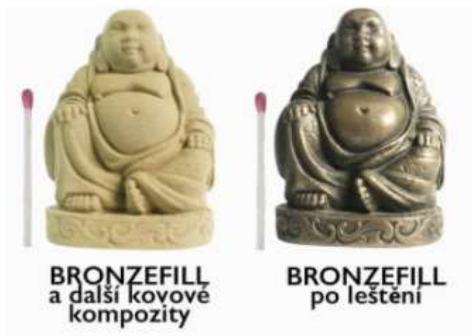
Obr. 8: Ukázka tisku pomocí filamentu Bronzefill [10]
