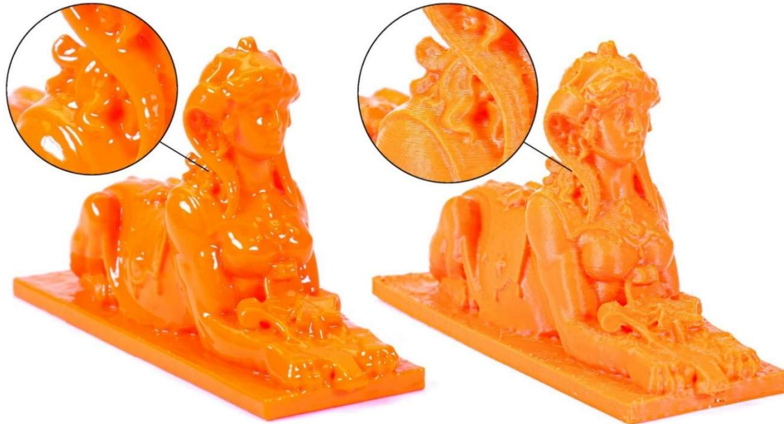
Obr. 3: Ukázka model vytištěného z materiálu ASA (vpravo) a modelu následně vyhlazeného acetonem (vlevo) [5]
