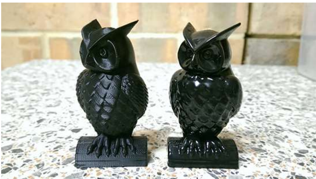
Obr. 2: Ukázka model vytištěného z materiálu ABS a modelu následně vyhlazeného acetonem (vpravo) [5]
