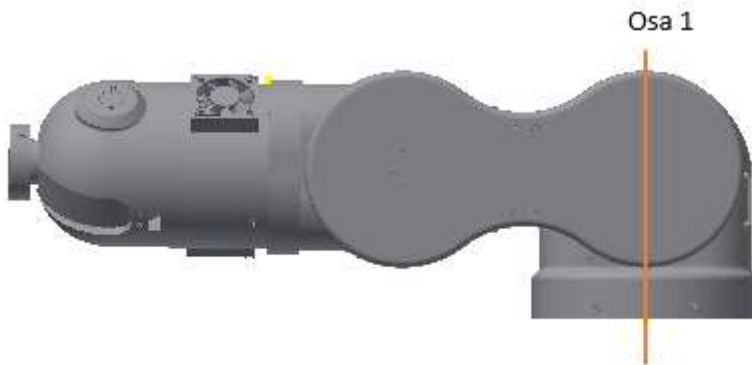
Obr. 79: Poloha ramene použita k výpočtu momentu setrvačnosti
