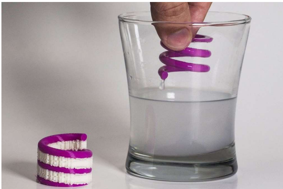
Obr. 10: Ukázka použití materiálu PVA pro podpory 3D tištěné součástí a jeho rozpustnost [4]
