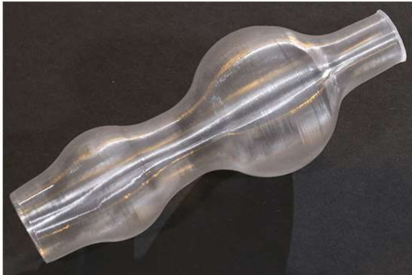
Obr. 4: Ukázka 3D tištěného modelu pomocí materiálu PETG [8]
