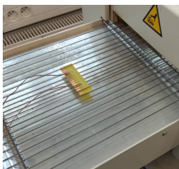
Obrázek 3.7: Připojené termočlánky na testovací DPS před průjezdem pecí.
