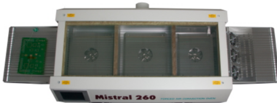
Obrázek 2.3: Tři vyhřívací pásma horkovzdušné pece [6].
