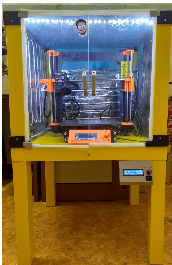
Obrázek 1. Vyhřívaný box - pohled zepředu
