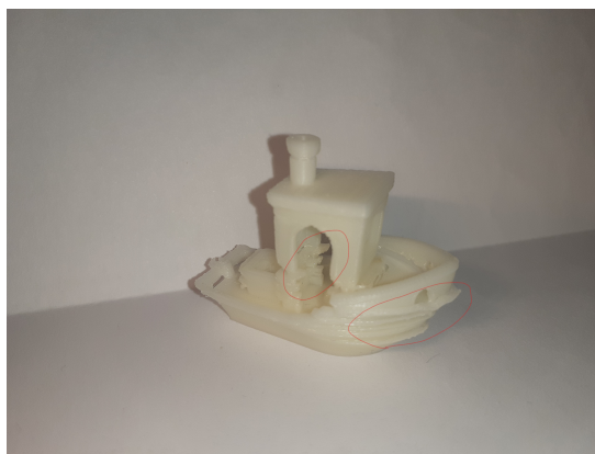
Obrázek 3.9: Nepovedený vzorek tištěný ve vyhřívaném boxu
