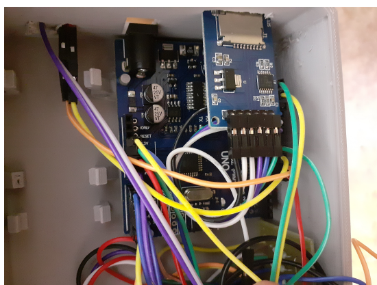
Obrázek 2.8: Vyhřívaný box - zapojení řídicího mikrokontroléru (krabička vlevo)
