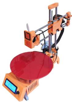
Obrázek 1.3: Polární 3D tiskárna R-360. Převzato z [17]
