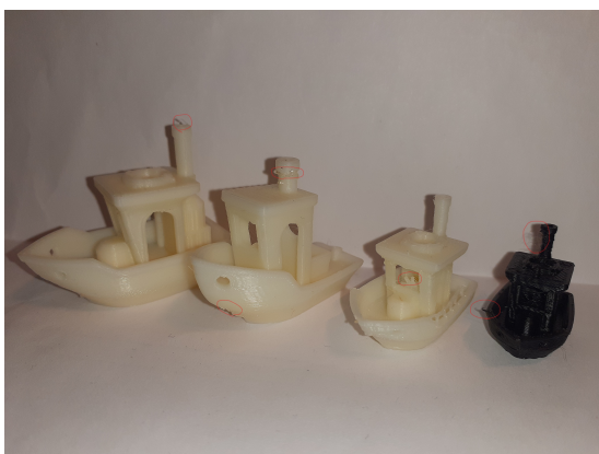
Obrázek 3.6: Vzorky tištěné bez vyhřívaného boxu
