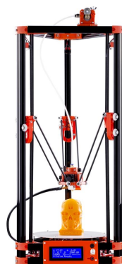
Obrázek 1.2: Delta 3D tiskárna FLSUN Delta Kossel. Převzato z [16]
