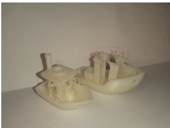
Obrázek 3.8: Nepovedené vzorky tištěné bez vyhřívaného boxu
