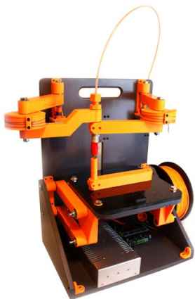
Obrázek 1.4: Scara 3D tiskárna. Převzato z [18]
