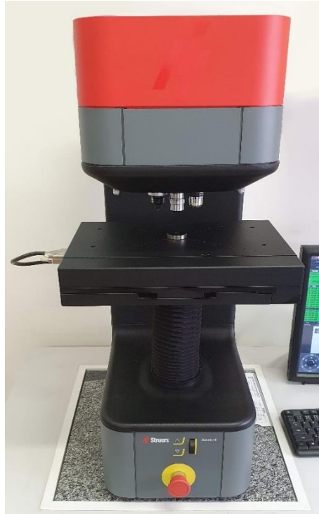
Obr. 24 Tvrdoměr Struers Duramin 40
