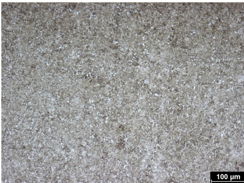
Obr. 19 Mikroskopický snímek martenzitické struktury.
