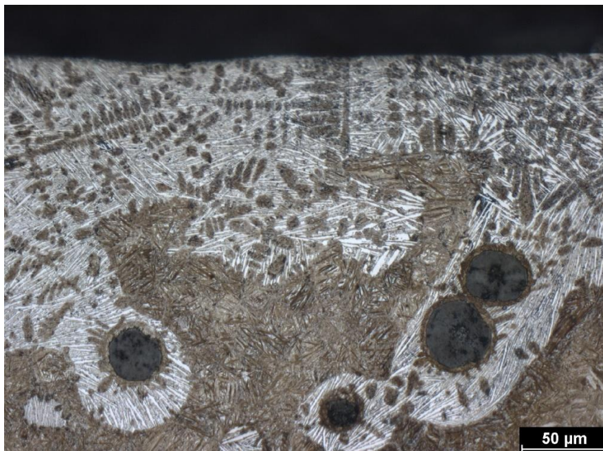
Obrázek 33 - Struktura povrchu vzorku ADI po laserovém povrchovém kalení
