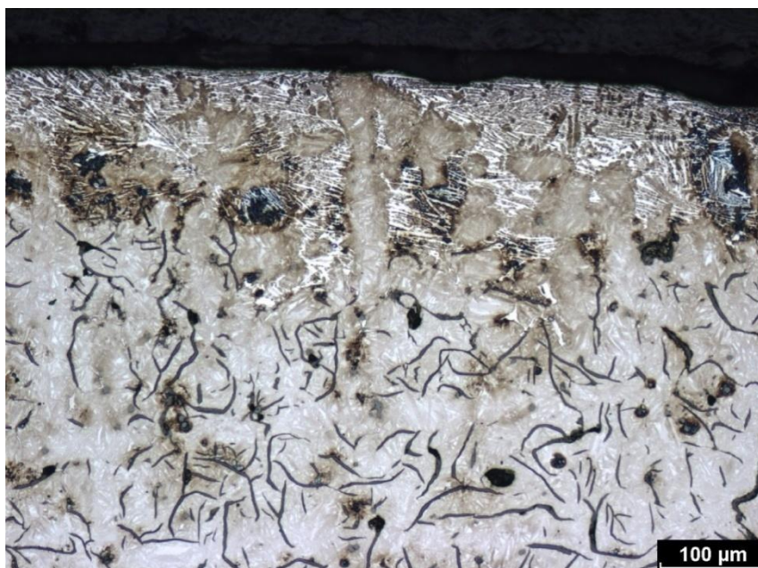
Obrázek 24 - Struktura laserově zakalené litiny EN GJL-200 AGI
