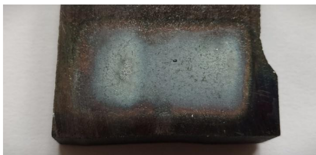
Obrázek 14 – Povrchově zakalený litinový vzorek
