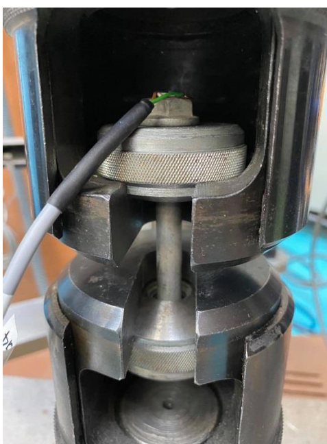
Obr. 19 – Šroub připravený na zatěžování v přístroji Tira 2300
