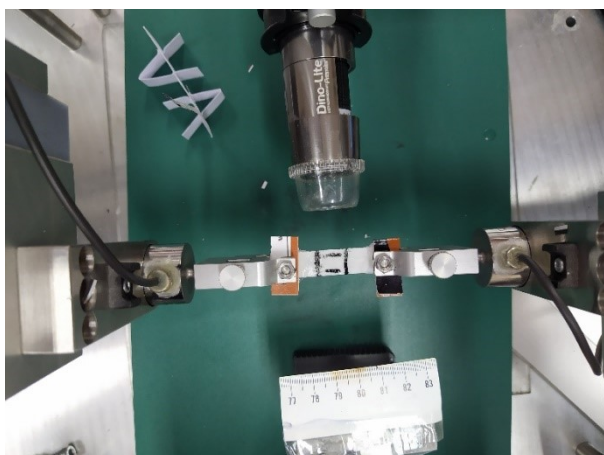
Obr. 19 Trhací stroj s upnutým vzorkem. Pohled shora.
