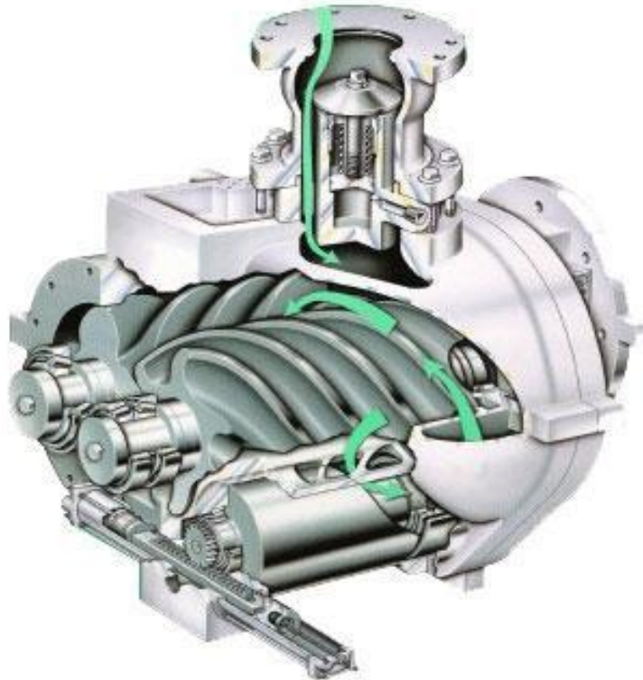
Obr. 3.6 Dvoušroubový kompresor [20]
