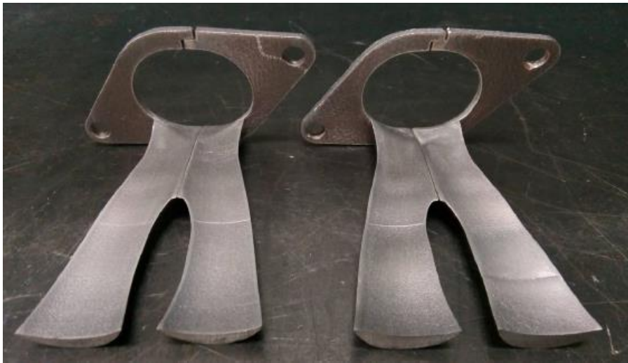
Obr. 53 – Hliníkové vložky sacích kanálov vyrobené sintrovaním [7]
