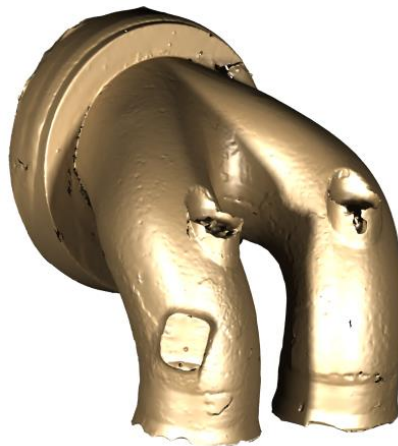
Obr. 22 – Sken odliatku výfukových kanálov (Yamaha YZF-R6)
