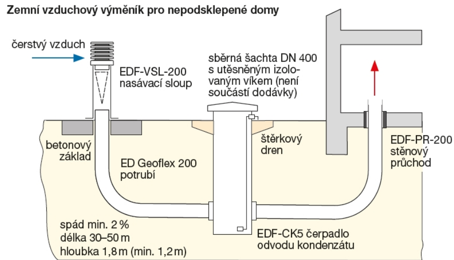
Obr. 24: Schéma systému zemního vzduchového výměníku [53]
