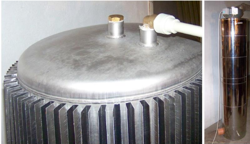
Obr. 6: Zásobníkový rekuperační výměník vzduch-voda [4]
