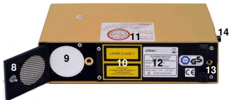
Obrázek 41: Ovládací prvky analyzátoru GRIMM 1.109 [36]
