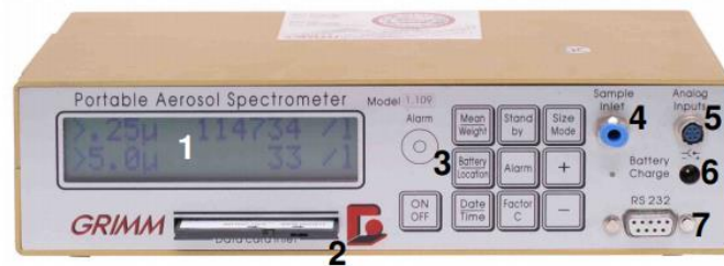
Obrázek 40: Ovládací prvky analyzátoru GRIMM 1.109 [36]
