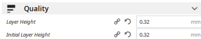
Obr. 38 – Nastavení výšky vrstvy - Ultimaker Cura 4.8.0
