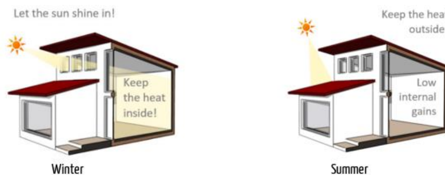
Obr. 12: Stínění přesahem střechy [14].
