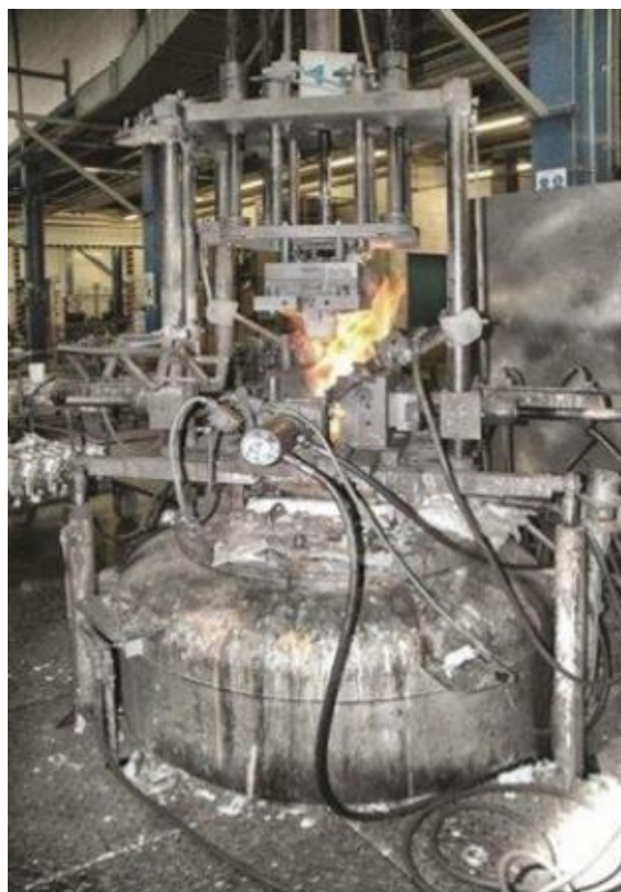
Obrázek 8: Nízkotlaký lící stroj: Zdroj: [21]
