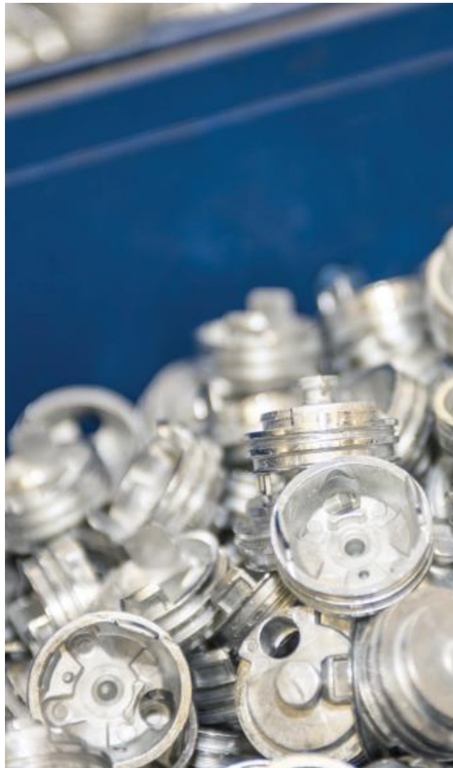
Obrázek 11: Vysokotlaké odlévání slitin zinku. Zdroj: [21]
