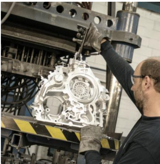
Obrázek 7: Gravitační a nízkotlaké odlévání slitin hliníku Zdroj: [21]
