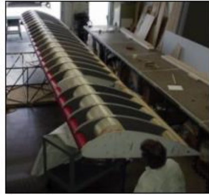
Obrázek 62 Nafukovací křídlo bez potahu [54]
