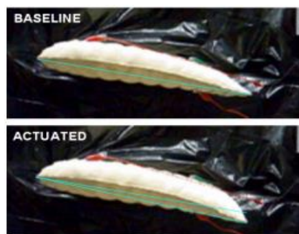
Obrázek 67 Křídlo s SMA dráty [54]
