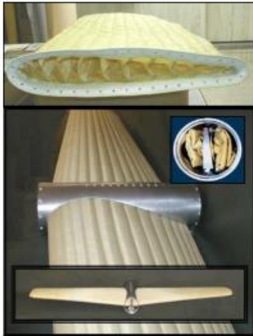
Obrázek 63 Řez křídlem a jeho rozložení [54]
