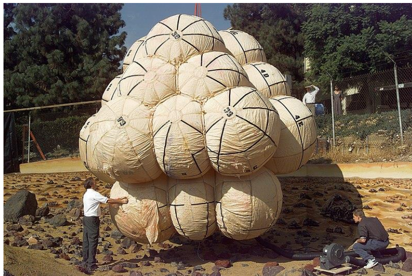
Obrázek 78 Systém airbagu u Pathfinder a MER [49]
