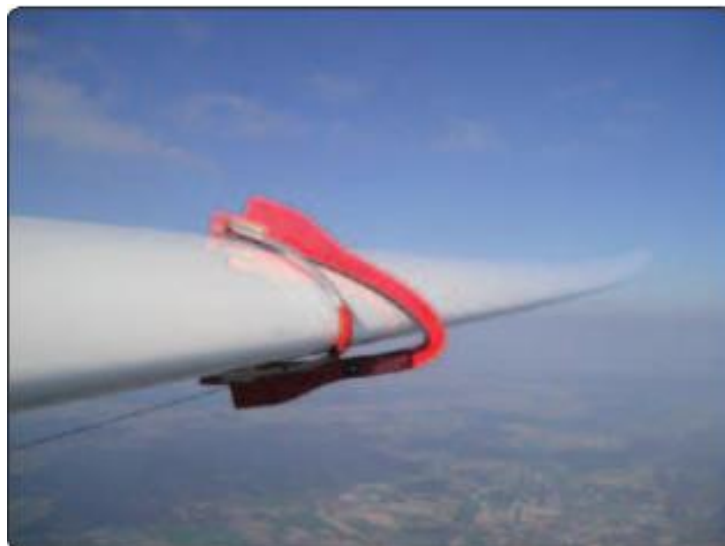
Obrázek 37 Stěrač hmyzu na křídle [26]
