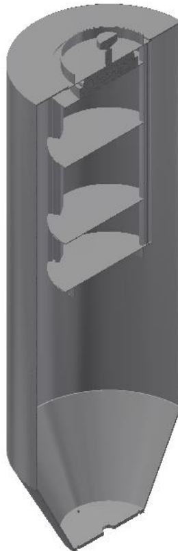
Obr. 33.: Řez 3D modelem pádové kapsle
