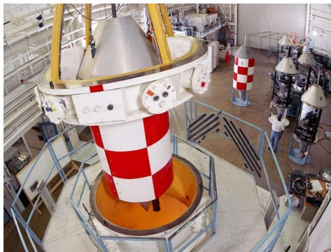
Obr. 10: Kapsle uložená v uvolňovacím mechanismu na vrchu tlakové komory [25]
