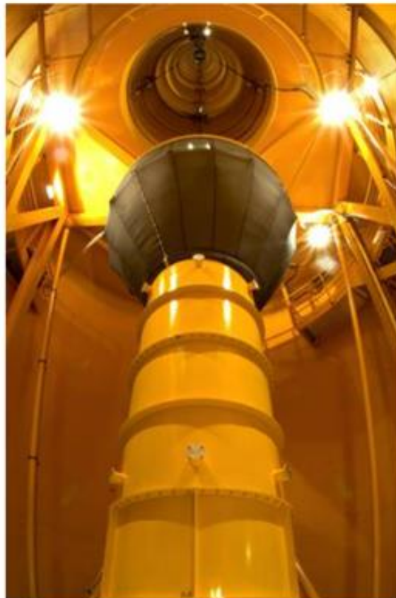
Obr. 1.: Fotografie zádržného systému z pádové věže v Brémách [1]
