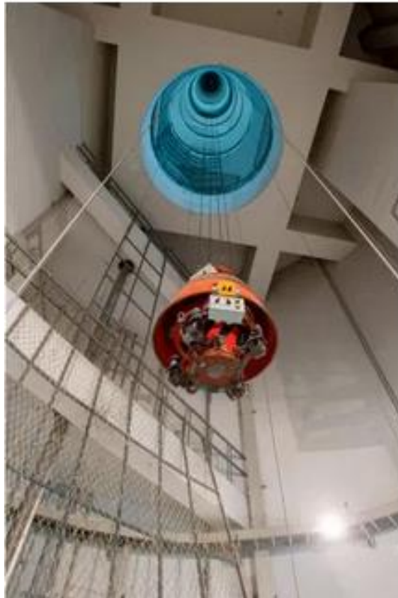
Obr. 27.: Fotografie lanového systému s kapslí v pádové věži NMLC [31]
