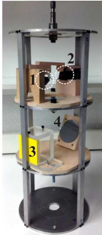
Obr. 24.: Fotografie konstrukce kapsle - 1. CCD kamera, 2. osvětlení, 3. experimentální náklad, 4. zrcadlo [20]
