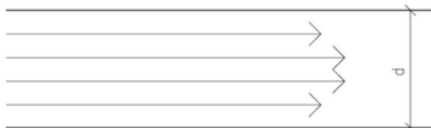
Obrázek 3 Schéma proudnic při laminárním proudění [8]
