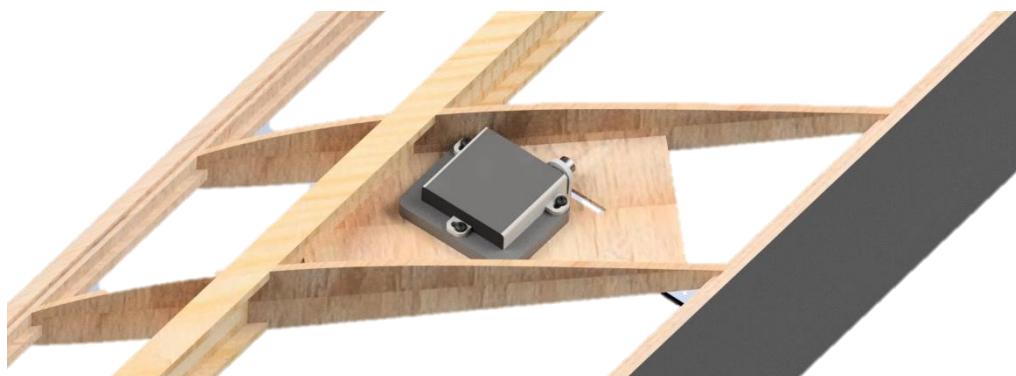
Obrázek 5.4 - Umístění serva v křídle
