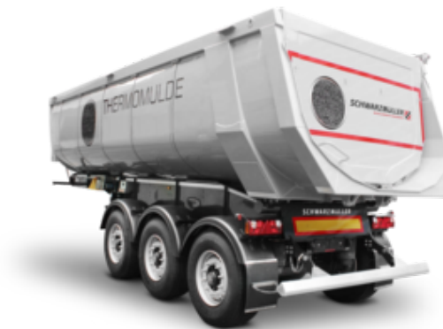
Obrázek 3.3. 3-nápravový sklápěcí návěs s hliníkovou a tepelně izolovanou korbou v segmentovém provedení. [13]
